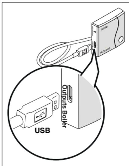
Alimentare il WiFi Box tramite l'apposito cavo e alimentatore forniti a corredo.
