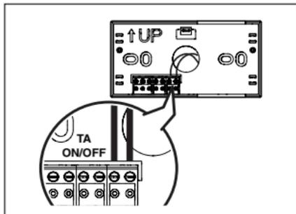
Cablaggio del **RiCLOUD** al termoconvettore:
