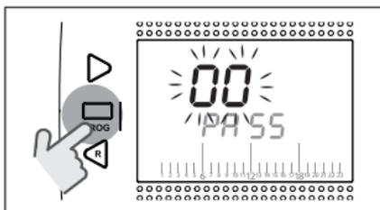
Premere il tasto UP  $\wedge$  o DOWN  $\vee$  per inserire la password installatore (password = 18).
