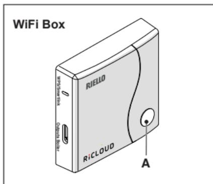
Con collegamento ON/OFF, premendo il tasto trasparente a bolla prismatica (A) è possibile attivare o disattivare il relè.
