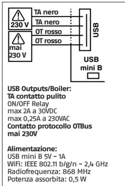
A corredo sono forniti 2 cavi USB, uno per alimentazione da alimentatore USB e l'altro per il collegamento del WiFi Box al termoconvettore.
