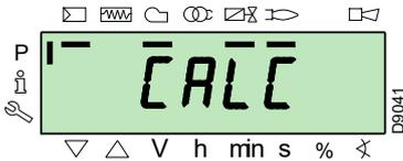
L'apparecchiatura calcolerà in automatico i punti da "P8" a "P2", distribuendoli in una retta. Essi sono teorici e devono essere verificati.
