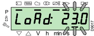
Per uscire dal modo manuale premere contemporaneamente i tasti "+" e "-" (ESC) per 3 secondi: il bruciatore funzionerà in automatico e la potenza dipenderà dal termostato/presostato di regolazione (TR).
