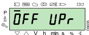
Accedere al Livello Parametri facendo riferimento alla "Procedura di accesso tramite password" a pag. 38. Il display visualizza il gruppo parametri 400.
