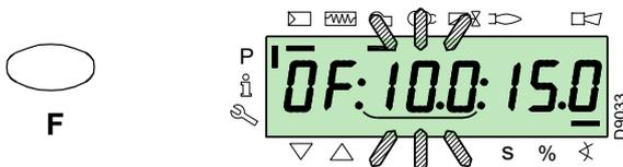
Per il servomotore dell'aria, tenere premuto il tasto "A" (la posizione in gradi lampeggia) e premere i tasti "+" o "-" per incrementare o diminuire il valore.
