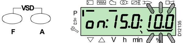
Selezionare un altro punto, oppure uscire premendo contemporaneamente i tasti "+" e "-" (ESC).
