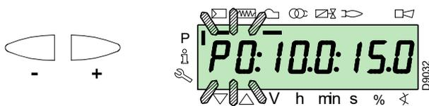
Per il servomotore del combustibile, tenere premuto il tasto "F" (la posizione in gradi lampeggia) e premere i tasti "+" o "-" per incrementare o diminuire il valore.
