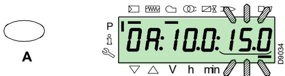
Per la regolazione della velocità dell'inverter (espressa in % e cioè 50 Hz = 100 %), tenere premuti contemporaneamente i tasti "F" e "A" la posizione in percentuale lampeggia e premere i tasti "+" o "-" per incrementare o diminuire il valore.
