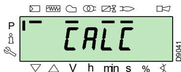
Il controllo fiamma riporterà automaticamente gli stessi valori impostati nei punti "P0" e "P1" ai punti da "P2" a "P8".
