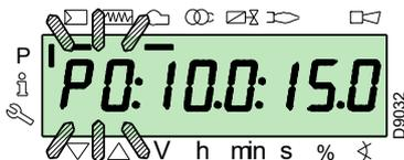
Per il servomotore del combustibile, tenere premuto il tasto "F" (la posizione in gradi lampeggia) e premere i tasti "+" o "-" per incrementare o diminuire il valore.
