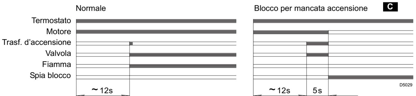
**C** Segnalato dalla spia sull'apparecchiatura di comando e controllo (3, fig. 1, pag. 1).
