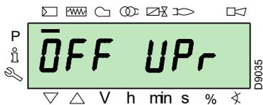
Accedere al Livello Parametri facendo riferimento alla "Procedura di accesso tramite password" a pag. 35. Il display visualizza il gruppo parametri 400.
