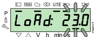
Per uscire dal modo manuale premere contemporaneamente i tasti "+" e "-" (ESC) per 3 secondi: il bruciatore funzionerà in automatico e la potenza dipenderà dal termostato/pressostato di regolazione (TR).
