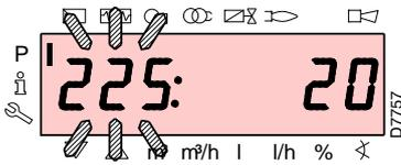
Dopo l'accesso al livello e al gruppo di parametri, il display visualizza sulla sinistra il numero del parametro (lampeggiante) e sulla destra il valore corrispondente.
