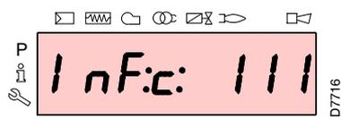
Il display visualizza alternativamente un codice ed una diagnostica di errore, che non porta il sistema in sicurezza.
