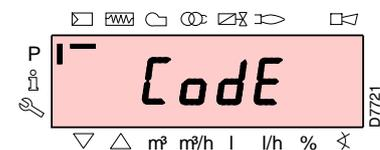
Premere contemporaneamente i tasti "F" e "A" per 1s: sul display appare per un istante "Code", e subito dopo appaiono 7 trattini di cui il primo lampeggiante.
