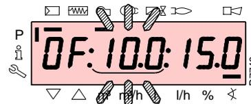
Per il servomotore dell'aria, tenere premuto il tasto "A" (la posizione in gradi lampeggia) e premere i tasti "+" o "-" per incrementare o diminuire il valore.
