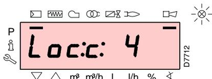
Il bruciatore è in blocco quando sul Pannello Operatore è accesa la spia rossa e il display visualizza alternativamente il codice di blocco (nell'esempio a lato **c: 4**) e la relativa diagnostica (nell'esempio **d: 3**).
