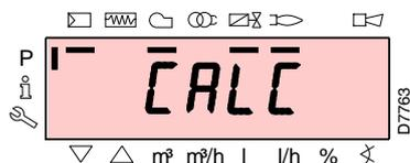
Dopo la regolazione del punto "P1" premere il tasto "+", sul display appare "CALC" per qualche secondo: l'apparecchiatura calcolerà in automatico i punti da "P2" a "P8", distribuendoli in una retta, assumendo per il punto "P9" l'impostazione di fabbrica (vedere la tabella sotto riportata). Essi sono teorici e devono essere verificati.
