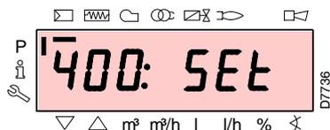
Accedere al Livello Parametri facendo riferimento alla “Procedura di accesso tramite password”. Il display visualizza il gruppo parametri **400**, confermare con il tasto “i/reset”.
