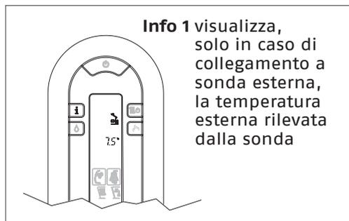
**Info 1** visualizza, solo in caso di collegamento a sonda esterna, la temperatura esterna rilevata dalla sonda
