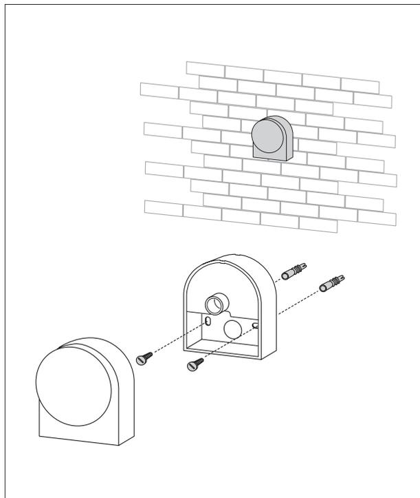
⚠ La sonda va posta in un tratto di muro liscio; in caso di mattoni a vista o di parete irregolare, va prevista un'area di contatto liscia
