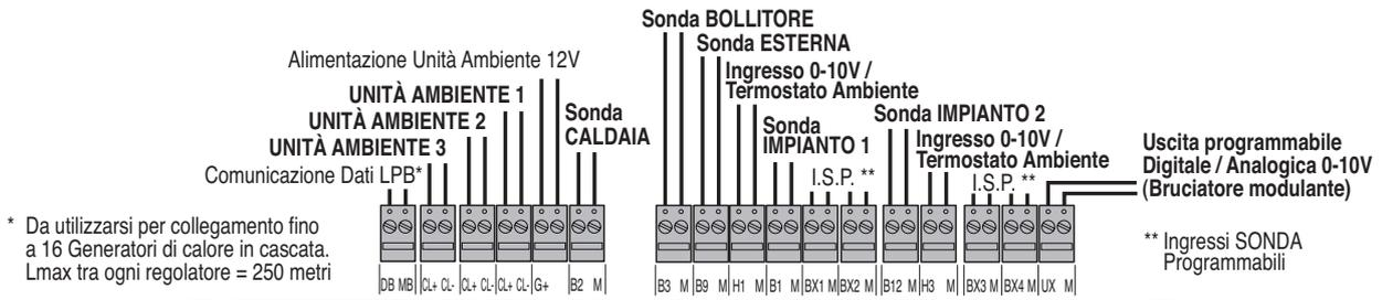
\* Da utilizzarsi per collegamento fino a 16 Generatori di calore in cascata. Lmax tra ogni regolatore = 250 metri
