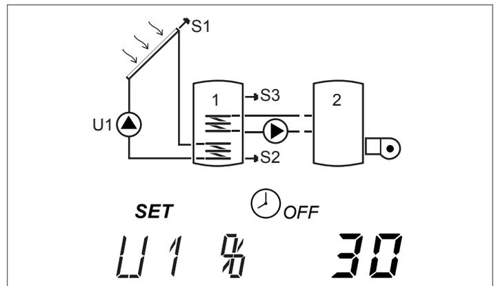
NOTA: Con pompe NON modulanti, viene visualizzato "100" quando la pompa è ferma e "0" quando la pompa è in funzione.
