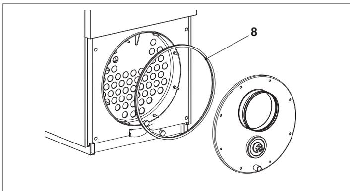
Completate le operazioni di pulizia rimontare tutti i componenti operando in maniera inversa a quanto descritto.
