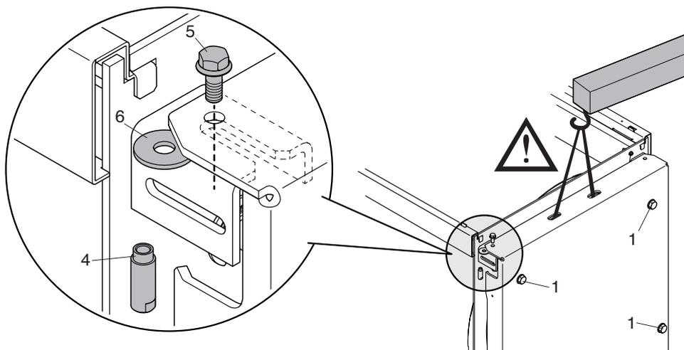
Invertendo la sequenza delle azioni ripristinare sul lato opposto la funzionalità di apertura.
