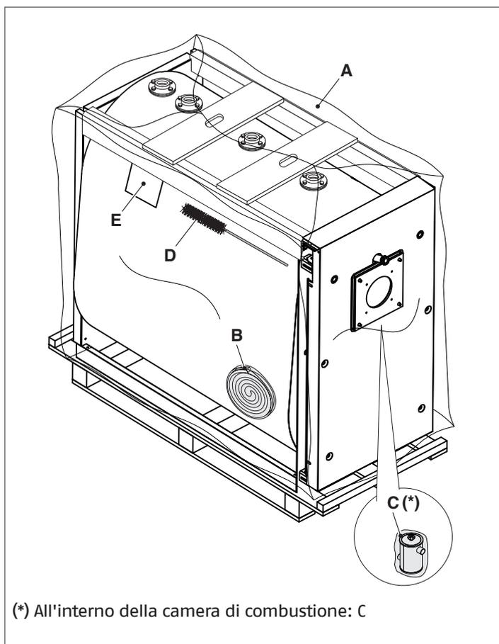
Il secondo collo contiene la pannellatura completa degli accessori di montaggio, protetta da un imballo in cartone e da una gabbia in legno.
