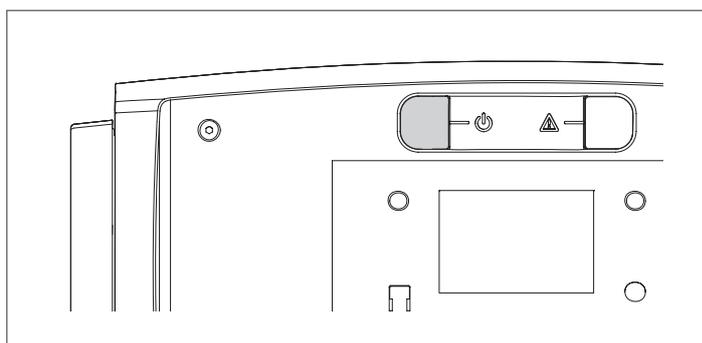
La caldaia effettuerà la fase di accensione ed una volta avviata resterà in funzione fino a quando saranno raggiunte le temperature regolate.
