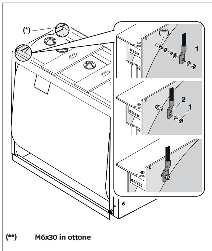
**!** Sul lato sinistro della testata è presente un altro foro (\*) dove è possibile eseguire il collegamento di messa a terra. Nel caso si decida di utilizzare il foro del lato sinistro per il collegamento della messa a terra si rende necessario rimuovere la minuteria presente sul foro del lato destro e applicarla al lato sinistro.
