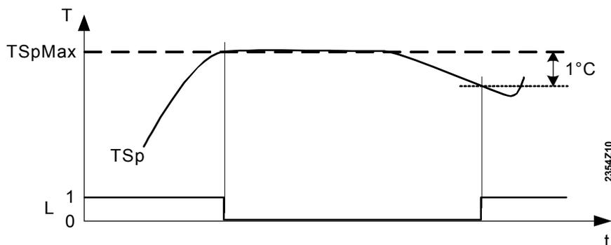
TSpMax Temperatura massima del serbatoio (Numero parametro 5051)
