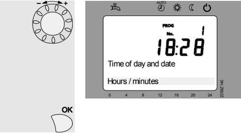
Nella sezione inferiore del display viene visualizzata la prima Funzione della pagina "Ora e data". Ruotare la manopola sino a quando viene visualizzata la Funzione "Ora / minuti". Premere il pulsante OK per confermare.
