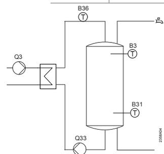
Scambiatore di calore esterno al serbatoio di accumulo con regolatore primario.
