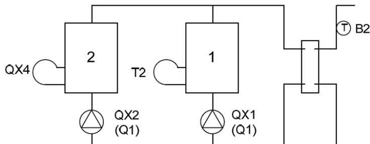
A causa del differenziale di temperatura tra il setpoint della temperatura della caldaia ed il sensore B2 temperatura della caldaia (comune, sensore di temperatura obbligatorio su collegamento in cascata), il ritardo di commutazione on / off della caldaia (integrale di attivazione e di reset) si realizza in base al controllo di un bruciatore a 2 stadi. Vengono utilizzati gli stessi parametri.
