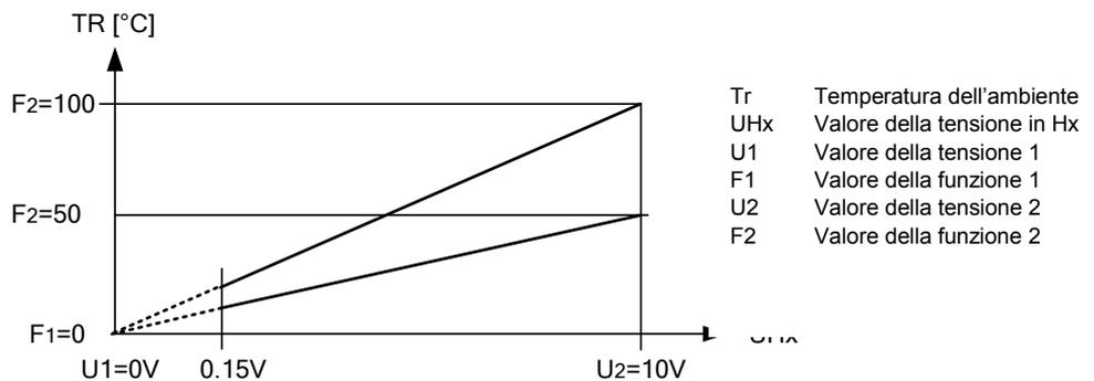
Se il valore misurato risulta inferiore a 0.15V, non verrà ritenuto valido e verrà trasmesso un messaggio di errore.
