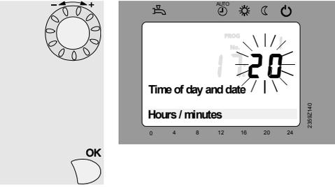
Il display mostra i minuti lampeggiante. Ruotare la manopola per impostare correttamente i minuti dell'ora. Premere il pulsante OK per confermare.
