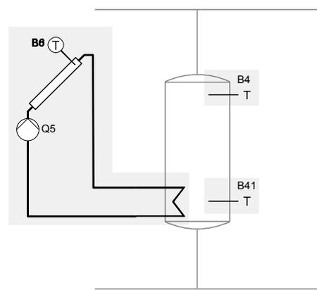
Riscaldamento solare del bollitore e della piscina mediante valvole deviatrici con 1 collettore
