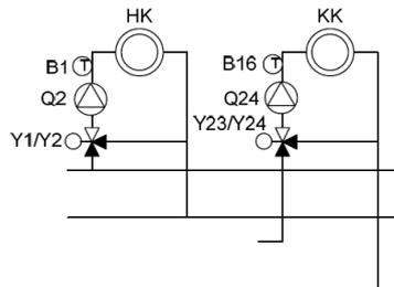
I circuiti di riscaldamento e raffreddamento assorbono la propria energia di raffreddamento/riscaldamento da circuiti primari separati.
