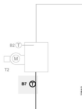
**Sensore di temperatura del condotto del gas di scarico**
