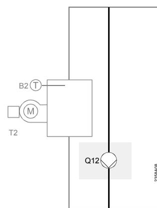
**Pompa della caldaia a combustibile solido**
