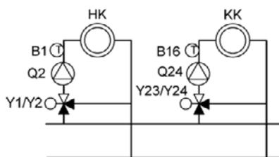
I circuiti di riscaldamento e raffreddamento assorbono la propria energia di raffreddamento/riscaldamento dallo stesso circuito primario.
