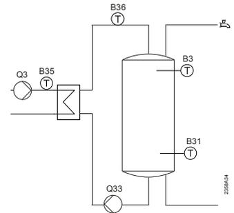
Controllo della velocità della pompa Q33 del circuito intermedio
