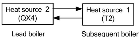
Passando alla commutazione automatica, la sorgente di calore 1 (T2) viene sempre attivata come caldaia principale.
