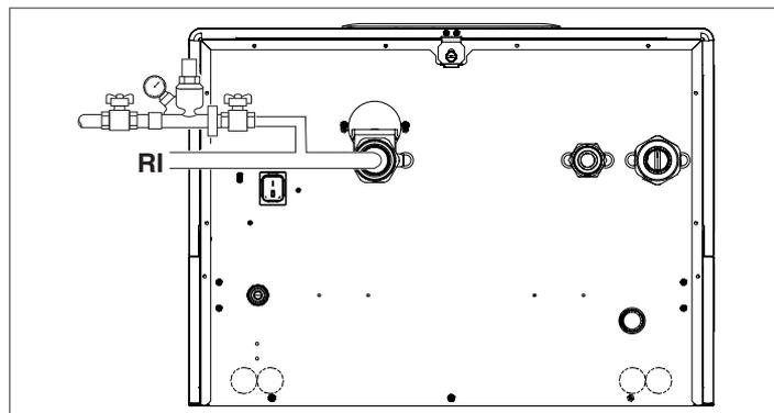
Prima di effettuare le operazioni di riempimento e svuotamento dell'impianto posizionare l'interruttore generale dell'impianto su spento (OFF) e l'interruttore principale del modulo termico su (0).
