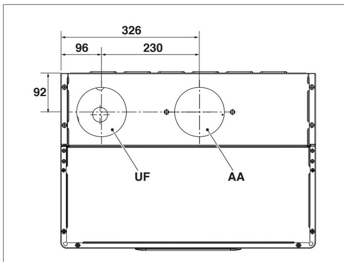
L'uscita AA esce di fabbrica tappata in configurazione B23.
