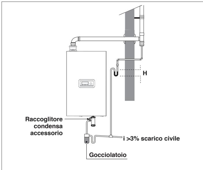
**⚠** Realizzare lo scarico della condensa in modo tale da impedire la fuoriuscita dei prodotti gassosi della combustione in ambiente o in fogna dimensionando il sifone (altezza H) come descritto nel paragrafo "Scarico dei prodotti della combustione".
