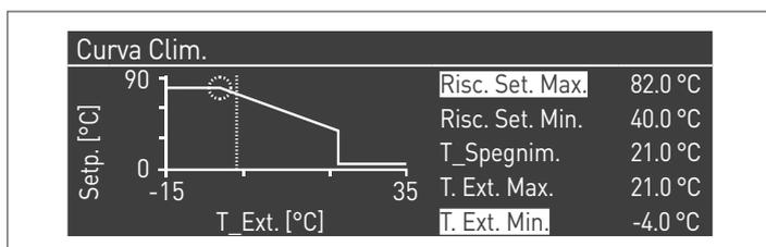
Il parametro "Comp. T. @ T.ext. Max", se diverso da 0, trasforma la curva climatica da lineare a quadratica consentendo di adattare meglio la variazione del setpoint alla variazione della temperatura esterna.
