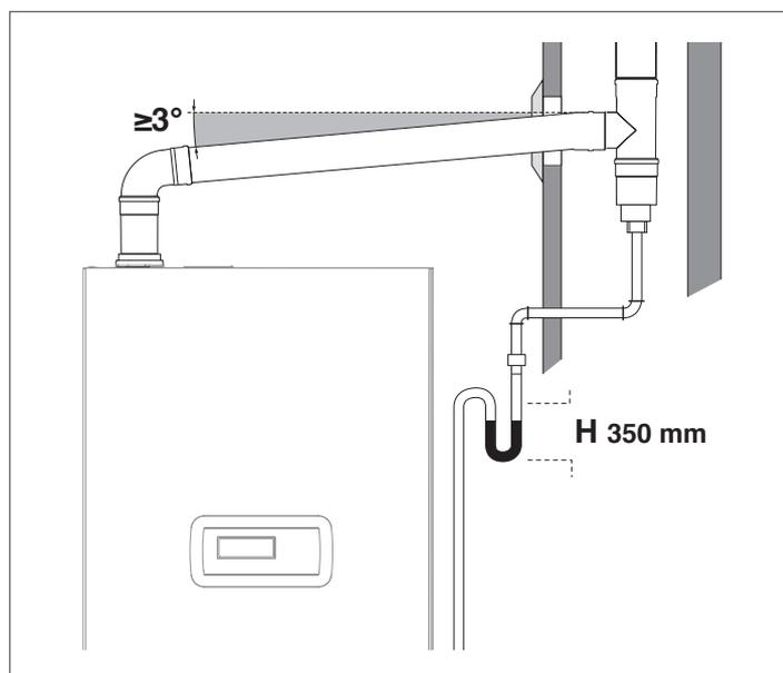
Per i cambi di direzione utilizzare un raccordo a T con tappo di ispezione il quale permette una facile pulizia periodica delle tubature. Accertarsi sempre che dopo la pulizia i tappi di ispezione vengano richiusi ermeticamente con la relativa guarnizione integra.
