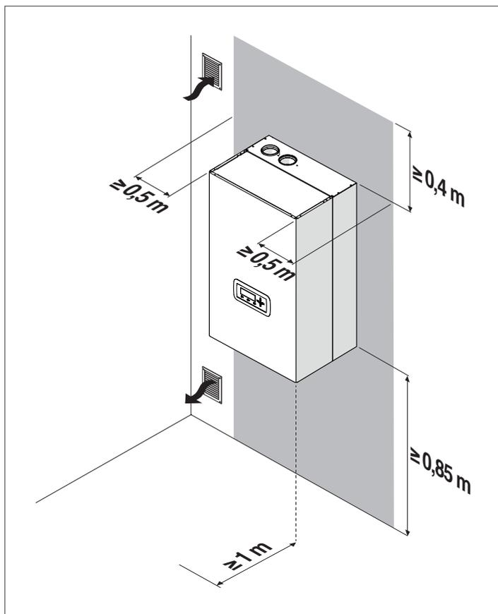
La superficie minima delle aperture di aerazione è di 3000 cm<sup>2</sup> per impianti di riscaldamento con combustibili gassosi.
