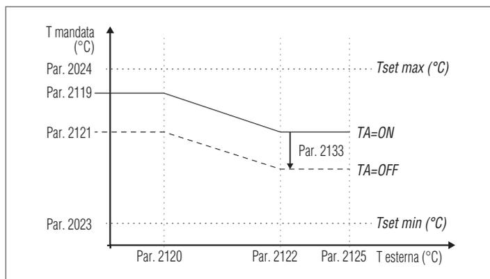
**⚠** Nel caso la sonda esterna (accessorio) non sia rilevata (non installata o danneggiata) il sistema effettua una richiesta di calore al massimo setpoint impostato sulla climatica.
