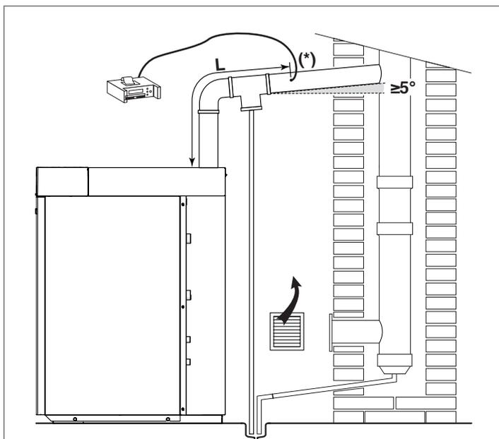
(\*) Il foro di prelievo per l'analisi fumi deve essere realizzato sul tratto rettilineo del condotto di scarico, sufficientemente lontano da curve o da gomiti. Per le dimensioni del foro e per conoscere la sua posizione corretta L sul condotto di scarico (distanza minima o massima da rispettare dall'uscita dell'apparecchio), fare riferimento alla normativa vigente.
