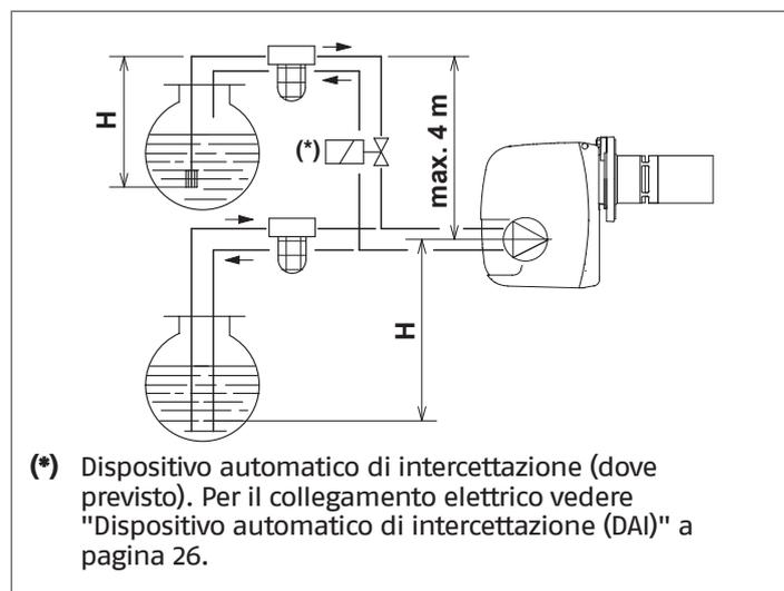
**⚠** Qualora sia prevista l'installazione di un'elettrovalvola di consenso nel circuito di alimentazione gasolio al bruciatore, prevedere esclusivamente impianto di tipo monotubo. Un'eventuale collegamento bitubo può compromettere il corretto funzionamento del bruciatore.
