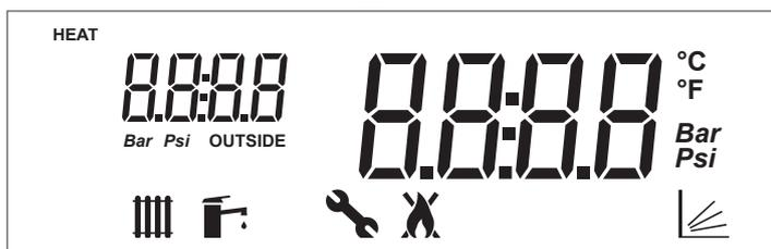
Versione firmware dell'interfaccia del gruppo termico. Nell'esempio il messaggio indica una versione firmware = 0.
