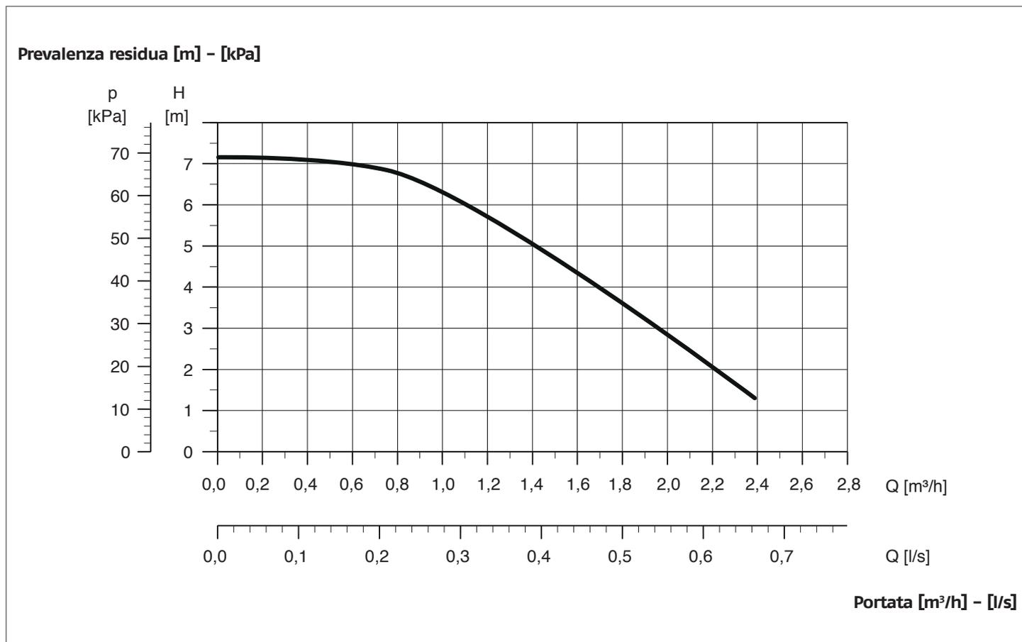
Le curve fanno riferimento ad una densità di 983.2 Kg/m<sup>3</sup>, una temperatura dell'acqua di +20°C e ad una viscosità cinematica di 0.474 mm<sup>2</sup>/s (0.474 cSt).
