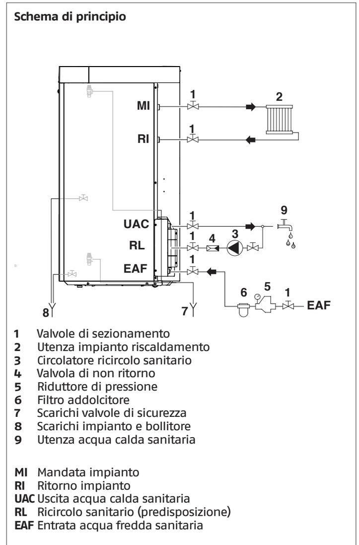
**⚠** Nei collegamenti idraulici all'utenza dell'impianto di riscaldamento non utilizzare una valvola di non ritorno.
