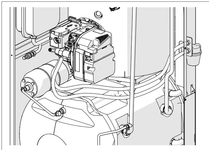
Il collegamento del tubo di mandata dell'alimentazione del gasolio deve essere eseguito direttamente sul filtro (1) (accessorio), il tubo di ritorno sul raccordo predisposto (2). Verificare che le connessioni realizzate siano a tenuta.
