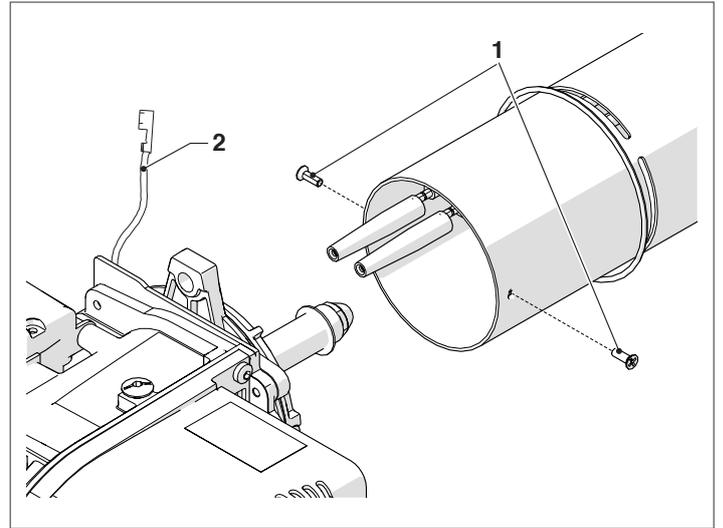
**⚠** Con il bocaglio smontato verificare il bordo anteriore dello stesso che deve essere con profilo regolare esente da incrostazioni, bruciature o deformazioni.
