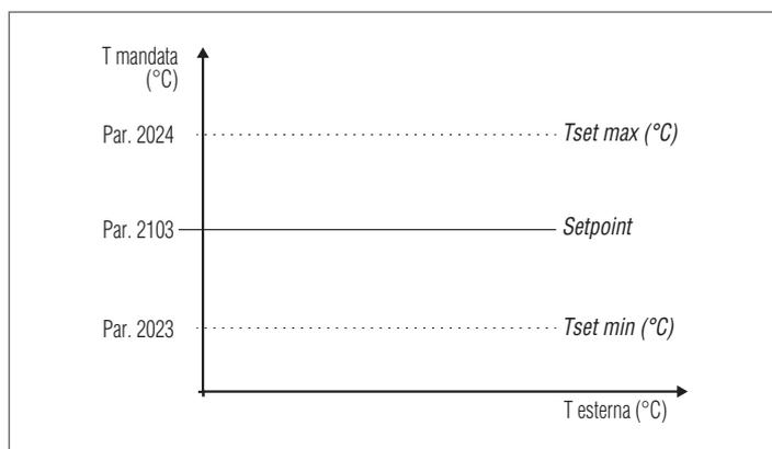
**Modalità 1:** funzionamento con termostato ambiente (TA/OT) richiesta calore e sonda esterna (accessorio)
