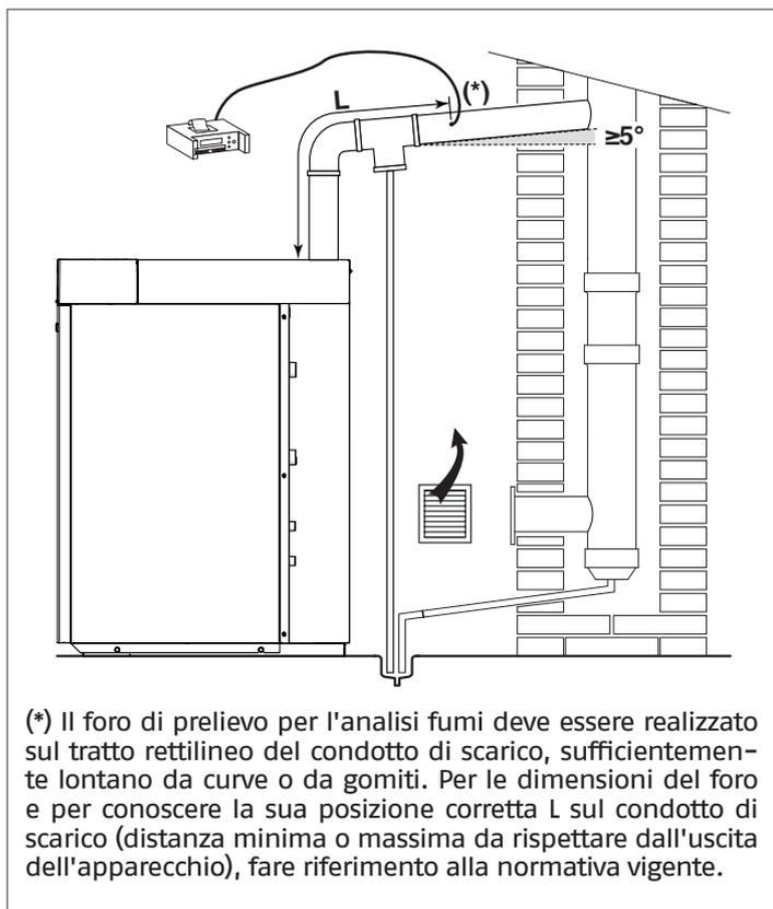
(\*) Il foro di prelievo per l'analisi fumi deve essere realizzato sul tratto rettilineo del condotto di scarico, sufficientemente lontano da curve o da gomiti. Per le dimensioni del foro e per conoscere la sua posizione corretta L sul condotto di scarico (distanza minima o massima da rispettare dall'uscita dell'apparecchio), fare riferimento alla normativa vigente.
