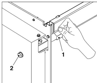
Successivamente richiudere ermeticamente il portello fissando i bulloni (2) in modo che si autosostenga in compressione sulla guarnizione a treccia. Rimuovere il tappo (1) facendo attenzione alla pressione della molla inserita nel tubo filettato.
