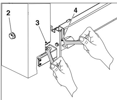
Rimontare la staffa sul lato opposto avendo cura che il cilindro sporgente sopra il dado (6) entri in sede. Eventualmente avvitare il dado (6) per alzarlo. Infine avvitare il bullone (3).
