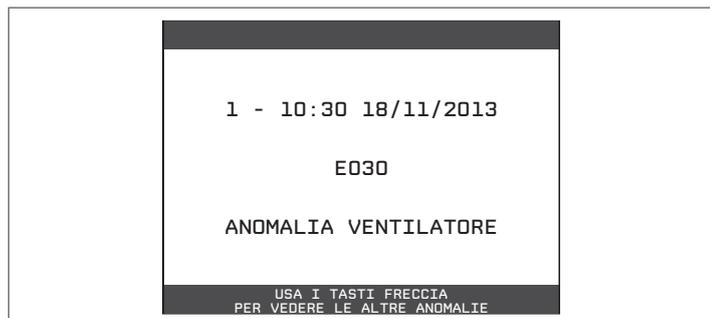
Nota: una volta abilitata, la funzione STORICO ALLARMI non può più essere disabilitata; non è prevista inoltre nessuna procedura che preveda l'azzeramento dello storico allarmi. Se un allarme si presenta più volte di seguito, viene memorizzato una volta soltanto.
