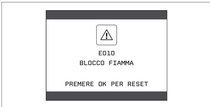
**!** In condizioni normali, con apparecchio in stato OFF, il bruciatore potrebbe accendersi per l'attivazione di una funzione antigelo oppure per l'attivazione della funzione analisi di combustione. In entrambi i casi la presenza di fiamma è segnalata dalla relativa icona ed il tipo di funzione in corso viene indicato nel messaggio scorrevole a piè di pagina sul REC10.
