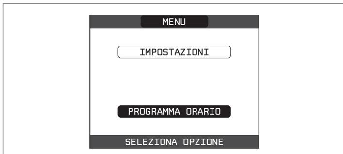
Da questo menù è possibile accedere alla visualizzazione e regolazione della programmazione oraria per le funzioni riscaldamento/raffrescamento di una zona piuttosto che per il carico del bollitore sanitario da caldaia.
