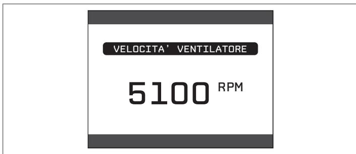
**Nota:** è possibile, in alternativa, modificare la velocità del ventilatore agendo sul trimmer P3 presente sulla scheda elettronica AKL06N (per fare questo è necessario aprire il coperchio del cruscotto per accedere alla componentistica elettronica).
