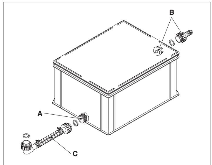
L'attacco di ingresso (A) dell'unità di neutralizzazione (più basso) deve essere collegato allo scarico della condensa della caldaia con il tubo flessibile di mandata (C) fornito con l'unità. Questo assicura che non vi siano fuoriuscite di prodotti della combustione attraverso la tubazione di scarico condensa della caldaia.
