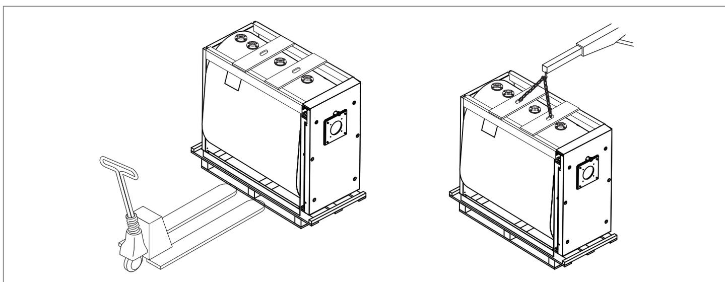
Le caldaie in acciaio **TAU N OIL PRO RIELLO** sono dotate di golfari di sollevamento. Porre attenzione alla movimentazione ed avvertersi di attrezzatura idonea ai loro pesi.
