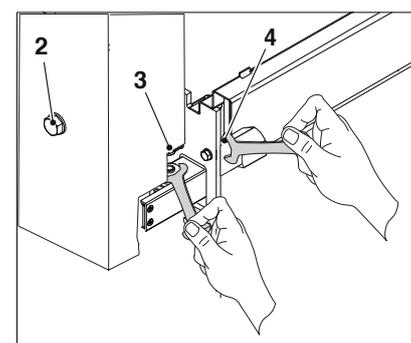
Rimontare la staffa sul lato opposto avendo cura che il cilindro sporgente sopra il dado (6) entri in sede. Eventualmente avvitare il dado (6) per alzarlo. Infine avvitare il bullone (3).
