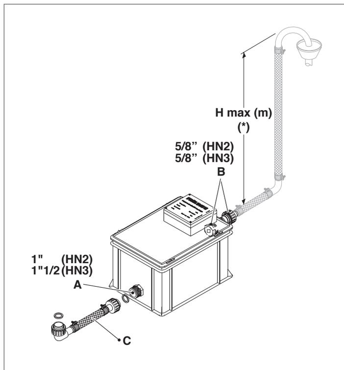
(\*) Il battente massimo che la pompa può vincere è dato dalla propria prevalenza massima diminuito della resistenza offerta dalla tubazione di scarico.
