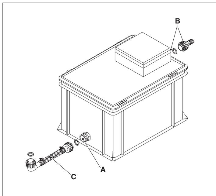
L'attacco di ingresso (A) dell'unità di neutralizzazione (più basso) deve essere collegato allo scarico della condensa della caldaia con il tubo flessibile di mandata (C) fornito con l'unità. Questo assicura che non vi siano fuoriuscite di prodotti della combustione attraverso la tubazione di scarico condensa della caldaia.
