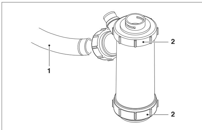
**!** È obbligatorio verificare e pulire il sifone e le tubazioni di evacuazione della condensa, fino al punto di raccolta/scarico, almeno una volta l'anno.
