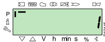
Dopo circa 5 secondi (dipende dalla durata del programma), il valore 0 appare sul display, esso sta ad indicare che il processo di backup è stato completato correttamente.
