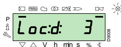
Il display visualizza alternativamente un codice ed una diagnostica di errore, che non porta il sistema in sicurezza.
