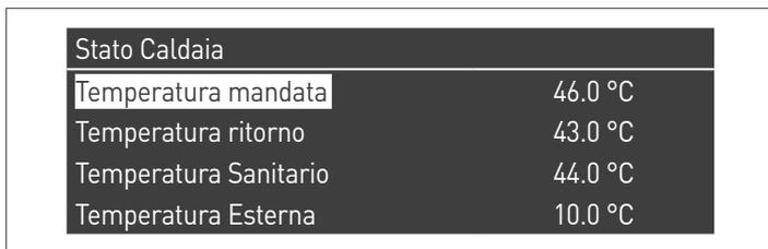
Selezionando "Registro caldaia" e premendo il tasto ● si visualizzano i seguenti valori:
