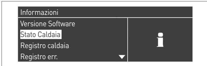
Selezionando "Stato caldaia" e premendo il tasto ● si visualizzano i seguenti valori:
