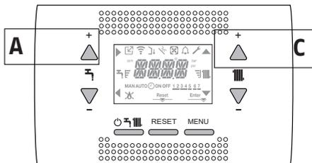
Tutte le volte che la caldaia è alimentata viene eseguito un ciclo di sfiato della durata di 4 min. Il display visualizza -AIR e si accende l'icona RE-SET. Per interrompere il ciclo di sfiato premere il tasto RE-SET. Portare la caldaia in stato OFF premendo il tasto **⏻**.
