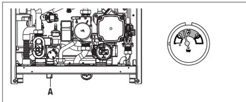
Con caldaia in anomalia E040 è necessario procedere al caricamento manuale agendo sul rubinetto di riempimento (A) sino a che la pressione raggiunge un valore compreso tra 1 e 1,5 bar. Successivamente premere RESET.
