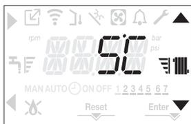
Nota: in presenza di sonda esterna collegata è comunque possibile far lavorare la caldaia a punto fisso andando ad impostare il parametro P4.18 = 0 (menu P4).
