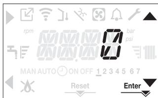
Se necessario l'interfaccia si posiziona automaticamente nel menu orologio. Sulla schermata principale si accendono le icone **▲**, **▼**, **▶** e **◀** e ENTER mentre la scritta 00:00 viene visualizzata con le prime due cifre lampeggianti con frequenza 0,5 sec ON, 0,5 sec OFF.
