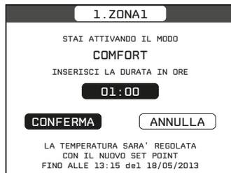
È possibile abbandonare in qualsiasi momento la programmazione di temperatura e durata del modo COMFORT mediante la pressione del tasto **BACK**.
