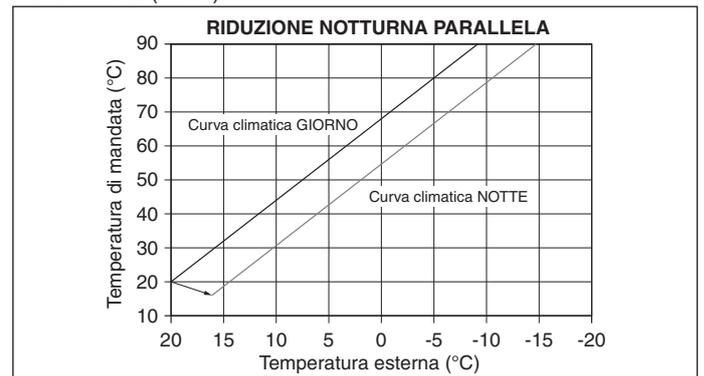
L'utente può indirettamente intervenire sul valore di setpoint RISCALDAMENTO andando ancora una volta ad introdurre, sul valore
