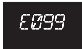
In questo caso è necessario togliere e ridare alimentazione elettrica alla caldaia per riattivare il funzionamento.
