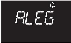
In questa condizione il sistema riprova l'esecuzione il giorno successivo. La caldaia continua a funzionare regolarmente, la segnalazione "ALEG" con campanella lampeggiante viene visualizzata solo quando caldaia in stand-by.
