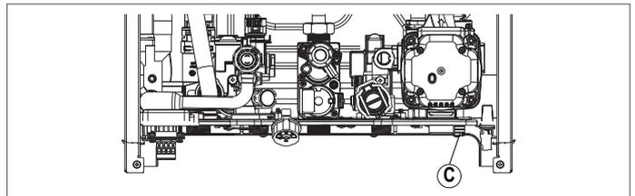
NOTA: le operazioni di **riempimento** dell'impianto devono essere fatte agendo sul rubinetto di riempimento (**esterno alla caldaia**) assicurandosi che la caldaia sia alimentata elettricamente.
