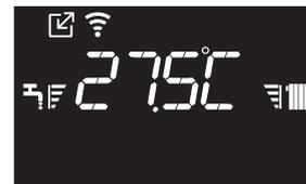
Nel menu INFO alla voce I036 (RADIO SIGNAL) è possibile visualizzare l'intensità del segnale radio (0 = molto debole, 1 = debole, 2 = buono, 3 = eccellente, 4 = molto buono).
