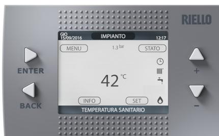
Il REC, dotato di un display a cristalli liquidi retro illuminato, assolve al molteplice ruolo di INTERFACCIA MACCHINA, controllo multi zona e regolatore ambientale. Nella parte superiore del display sono riportate le informazioni relative alla data e all'ora correnti e, se disponibile, il valore della temperatura esterna rilevata. Sui lati destro e sinistro sono visualizzate le icone che indicano lo stato del sistema, il loro significato è il seguente:
