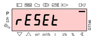
Per sbloccare premere il tasto “**i/reset**” per 1s: sul display appare “**rESEt**”. Al rilascio del tasto scomparirà la segnalazione di blocco e si spegnerà la spia rossa. L'apparecchiatura è sbloccata.
