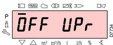
Verificare che il display del Pannello Operatore visualizzi la richiesta di calore e “OFF Upr”: ciò significa che è necessario impostare la curva di modulazione del bruciatore.
