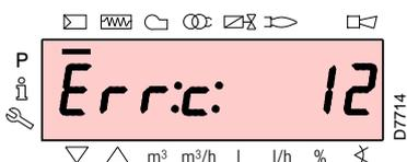
Il display visualizza alternativamente il codice di errore (nell'esempio a lato c: 12) e la relativa diagnostica (nell'esempio d: 0).
