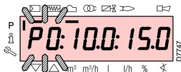
Utilizzando i tasti "+" e "-" inserire/selezionare il punto della curva desiderato ed attendere che esso lampeggi: ciò significa che i servomotori si sono posizionati sui valori visualizzati sul display e che corrispondono al punto impostato in precedenza. Ora è possibile inserire/modificare la posizione in gradi.
