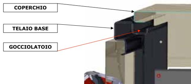
Per ottenere il grado di protezione necessario per l'installazione all'esterno (IPX5D) è sufficiente installare sul codice standard un kit specifico comprendente solo quattro staffette per la protezione della parte idraulica ed un coperchio per la protezione del quadro di controllo.
