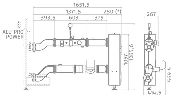
(\*) L'ingombro del separatore idraulico varia a seconda della potenza del generatore: 280 mm fino a 300 kW - 335 mm fino a 600 kW.
