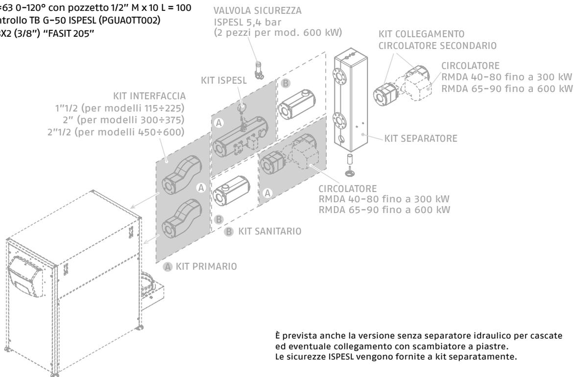
È prevista anche la versione senza separatore idraulico per cascate ed eventuale collegamento con scambiatore a piastre. Le sicurezze ISPEL vengono fornite a kit separatamente.
