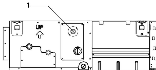
1 Attacco scarico condensa (pompa)
