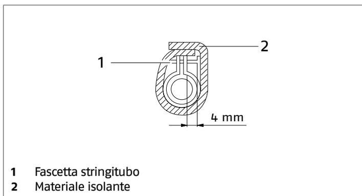
— isolare i punti di giunzione
