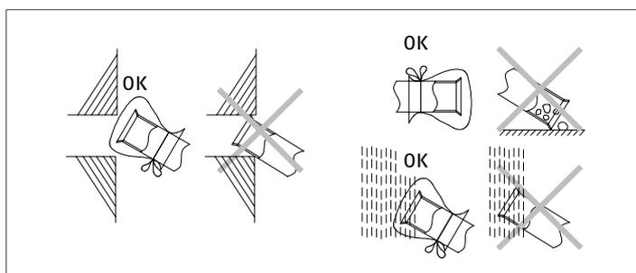
**⚠** Prima di inserire le linee attraverso il foro sul muroappare le estremità.
