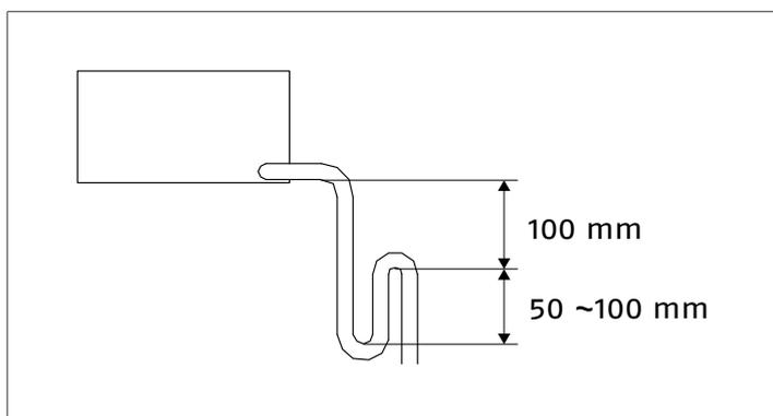
**⚠** Il sistema di scarico deve prevedere un adeguato sifone per prevenire l' indesiderata entrata d'aria nel sistema in depressione. Il sifone inoltre impedisce l'infiltrarsi di odori o insetti.
