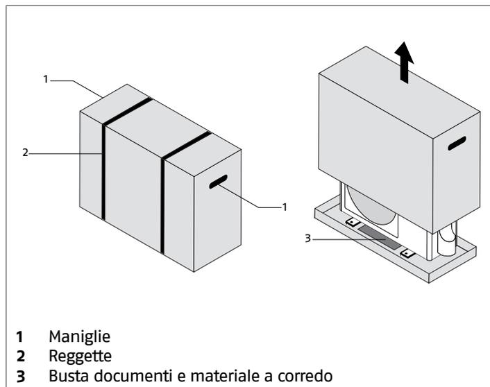
A seguire sono indicate le operazioni di rimozione dell'imballo e movimentazione dell'unità:
