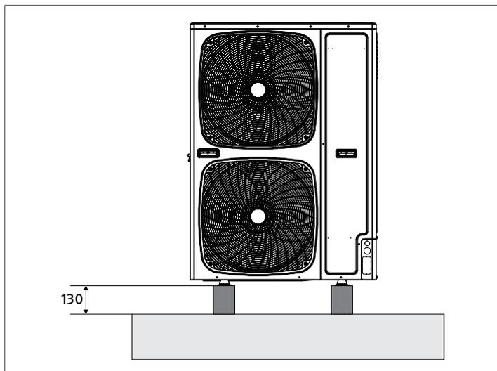
**⚠** In caso di installazione in zone soggette a forti nevicate, prevedere il sollevamento dell'unità ad una altezza sufficiente ad evitare l'ostruzione del flusso d'aria ed eventualmente una tettoia a protezione.
