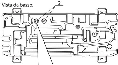
Questo foro di scarico è coperto da un tappo in gomma. Se un foro di scarico non è in grado di soddisfare i requisiti, è possibile utilizzare contemporaneamente anche l'altro.
