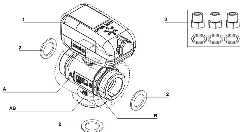
1. Valvola deviatrice idr. 3 vie motorizzata a sfera **SPST** 230 Vac-50/60 Hz - attacco M 1"1/4
