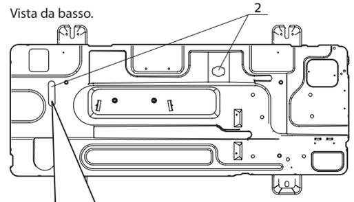
Questo foro di scarico è coperto da un tappo di gomma. Se il foro di scarico piccolo non può soddisfare i requisiti di scarico, si può utilizzare contemporaneamente il foro di scarico grande.
