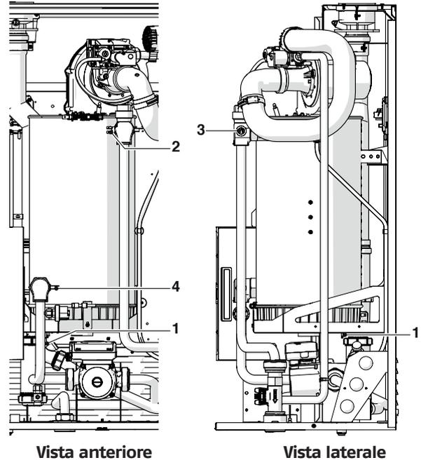
Sonde inserite negli appositi pozzetti del modulo termico (Condexa PRO 57 P ÷ Condexa PRO 135):
