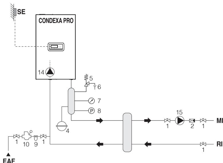
**Schema 4: circuito con modulo termico collegato con serbatoio A.C.S. e con impianto di riscaldamento tramite separatore**
