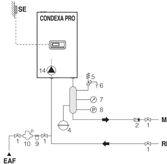
**Schema 2: circuito con modulo termico collegato direttamente con impianto di riscaldamento e serbatoio A.C.S. (verificare che la prevalenza della pompa sia sufficiente a garantire l'adeguata circolazione)**
