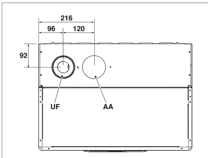
L'uscita AA esce di fabbrica tappata in configurazione B23.
