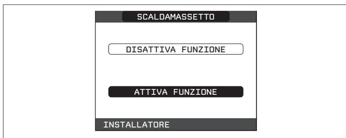
La funzione scaldassetto, quando attiva, viene segnalata nella schermata principale dal messaggio scorrevole a piè di pagina FUNZIONE SCALDAMASSETTO IN CORSO – TEMPERATURA DI MANDATA, 41
