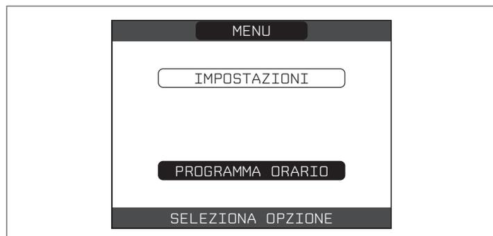
Da questo menù è possibile accedere alla visualizzazione e regolazione della programmazione oraria per le funzioni riscaldamento/raffrescamento di una zona piuttosto che per il carico del bollitore sanitario da caldaia e da pompa di calore (se installata). Per ciascun giorno della settimana è possibile impostare fino a 4 fasce, caratterizzate da un orario di inizio e un orario di fine.
