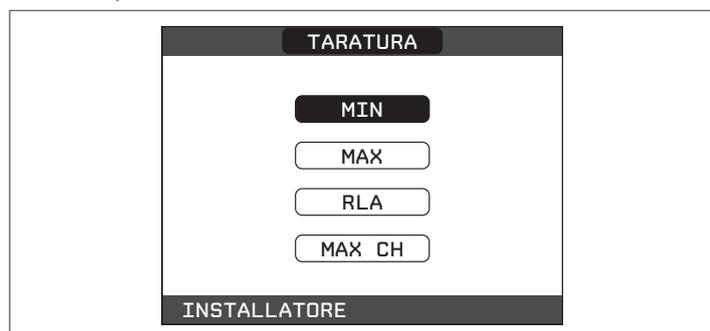
**⚠** La taratura non comporta l'accensione della caldaia.
