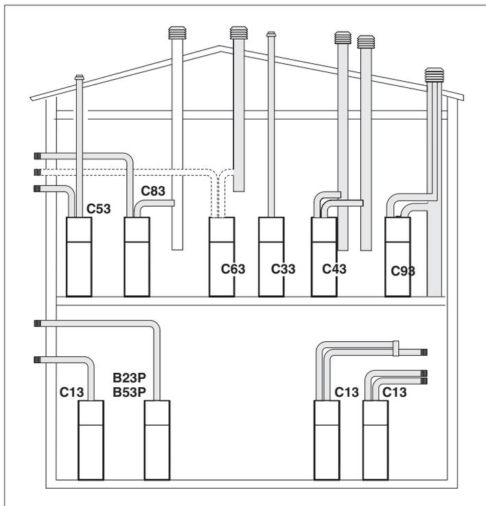
**B23P** Ventilatore a monte. Aspirazione aria comburente direttamente dal locale dov'è installata la caldaia. Scarico gas combustibili a mezzo di condotti orizzontali o verticali progettati per operare ad una pressione positiva, e predisposte prese di ventilazione.
