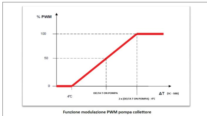
Tale modulazione PWM agisce in percentuale sul periodo di ON della pompa collettore CS rispetto ad un periodo di tempo che è dato dal valore del parametro [PWM POMPA COLLETTORE].
