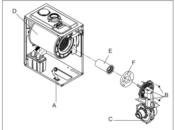
**Smontaggio del ventilatore e del mixer**
