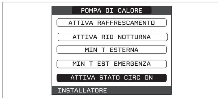
Il circolatore della pompa di calore continuerà a funzionare fino a quando non viene impostato nuovamente lo stato AUTO oppure fino a che la caldaia non viene messa in stato INVERNO o ESTATE. L'attivazione della funzione viene segnalata da un messaggio scorrevole a pie' di pagina nella schermata principale del REC10H
