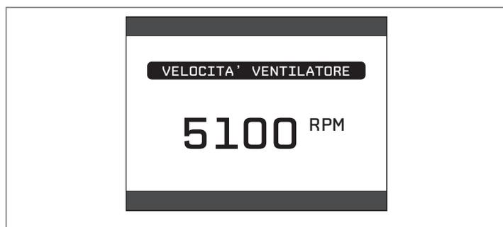
**Nota:** è possibile, in alternativa, modificare la velocità del ventilatore agendo sul trimmer P3 presente sulla scheda elettronica AKL06N (per fare questo è necessario aprire il coperchio del cruscotto per accedere alla componentistica elettronica).
