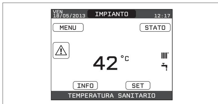
Trascorso il tempo transitorio, se l'anomalia persiste, viene visualizzato il codice di anomalia E040. Con caldaia in anomalia E040 è necessario procedere al caricamento manuale agendo sul rubinetto di riempimento sino a che la pressione raggiunge un valore compreso tra 1 e 1,5 bar.
