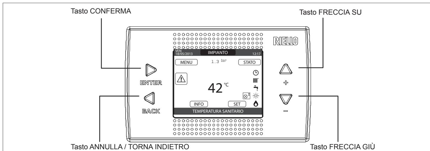
Il REC10H, dotato di un display a cristalli liquidi retro illuminato, assolve al molteplice ruolo di INTERFACCIA MACCHINA, CONTROLLO MULTI ZONA E REGOLATORE AMBIENTALE.
