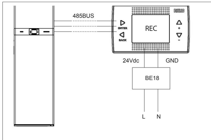
NOTA - È raccomandabile che l'alimentatore BE18 venga installato in prossimità del REC10H da alimentare, il collegamento del REC10H con la caldaia è a 3 fili!
