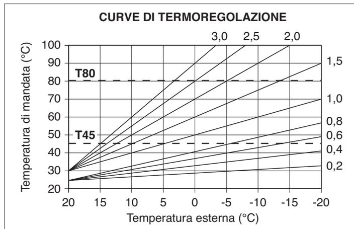
**T80** massima temperatura setpoint riscaldamento impianti standard
