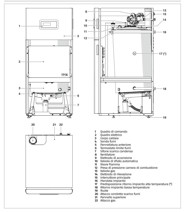
(\*) In base alla tipologia impiantistica è possibile collegare il ritorno impianto alta temperatura utilizzando il tubo di collegamento del ritorno impianto bassa temperatura già presente, assicurandosi che l'attacco non utilizzato sia chiuso con il tappo tolto in precedenza.
