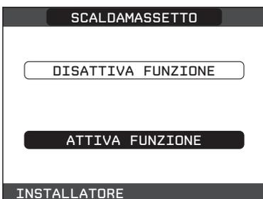
La funzione scaldassetto, quando attiva, viene segnalata nella schermata principale dal messaggio scorrevole a piè di pagina FUNZIONE SCALDAMASSETTO IN CORSO – TEMPERATURA DI MANDATA, mentre sulla scheda elettronica lampeggiano in modo alternato i led rosso e verde con frequenza 1sec ON – 1sec OFF.
