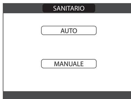
Selezionando **AUTO** la gestione del sanitario avviene con programmazione oraria. Quest modalità permette di settare delle fasce orarie a cui assegnare il set COMFORT (più alto). Al di fuori di tali fasce l'unità utilizza un set ECO (più basso).
