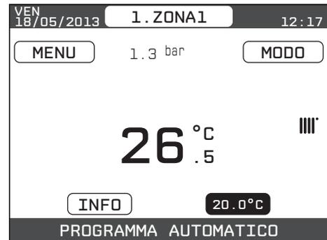
Una volta confermata la selezione, apparirà una nuova schermata dove sarà possibile impostare la durata del modo **COMFORT**. Per la modifica è necessario premere i tasti **SU** e **GIÙ**. È possibile effettuare una selezione compresa fra 30 minuti e 24 ore a intervalli di 30 minuti.
