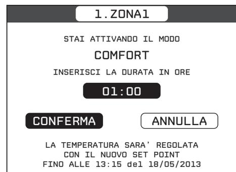
È possibile abbandonare in qualsiasi momento la programmazione di temperatura e durata del modo **COMFORT** mediante la pressione del tasto **ANNULLA**.
