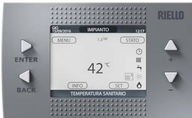
Il REC10MH, dotato di un display a cristalli liquidi retro illuminato, assolve al molteplice ruolo di interfaccia macchina, controllo multi zona e regolatore ambientale. Se presenti, il pannello di controllo consente anche la gestione delle funzioni correlate alla pompa di calore.
