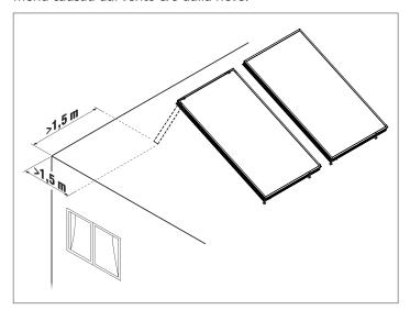
I collettori devono essere installati a distanza di sicurezza da parti attive di linee elettriche e di impianti elettrici come definito dalle leggi e regolamenti vigenti nel paese di installazione.
