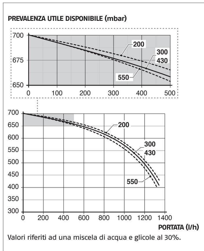
La velocità del circolatore è controllata da segnale PWM e varia in funzione al salto termico tra collettori solari e accumulo. Porre attenzione alle perdite di carico complessive del sistema (scambiatore, collettori solari e tubazioni) alle condizioni di portata massima prevista.
