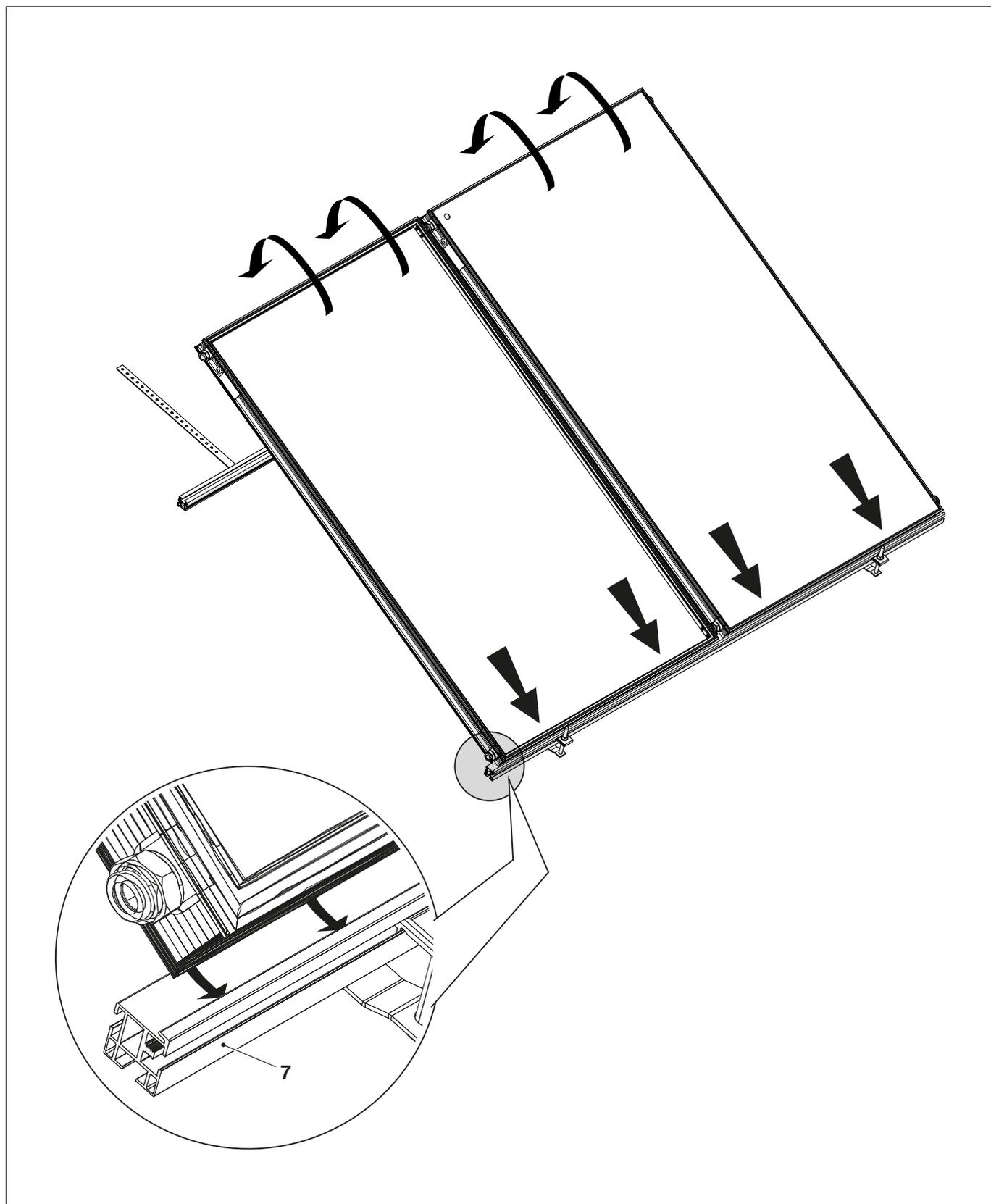
Fissare il collettore con le staffe di bloccaggio superiori (3).
