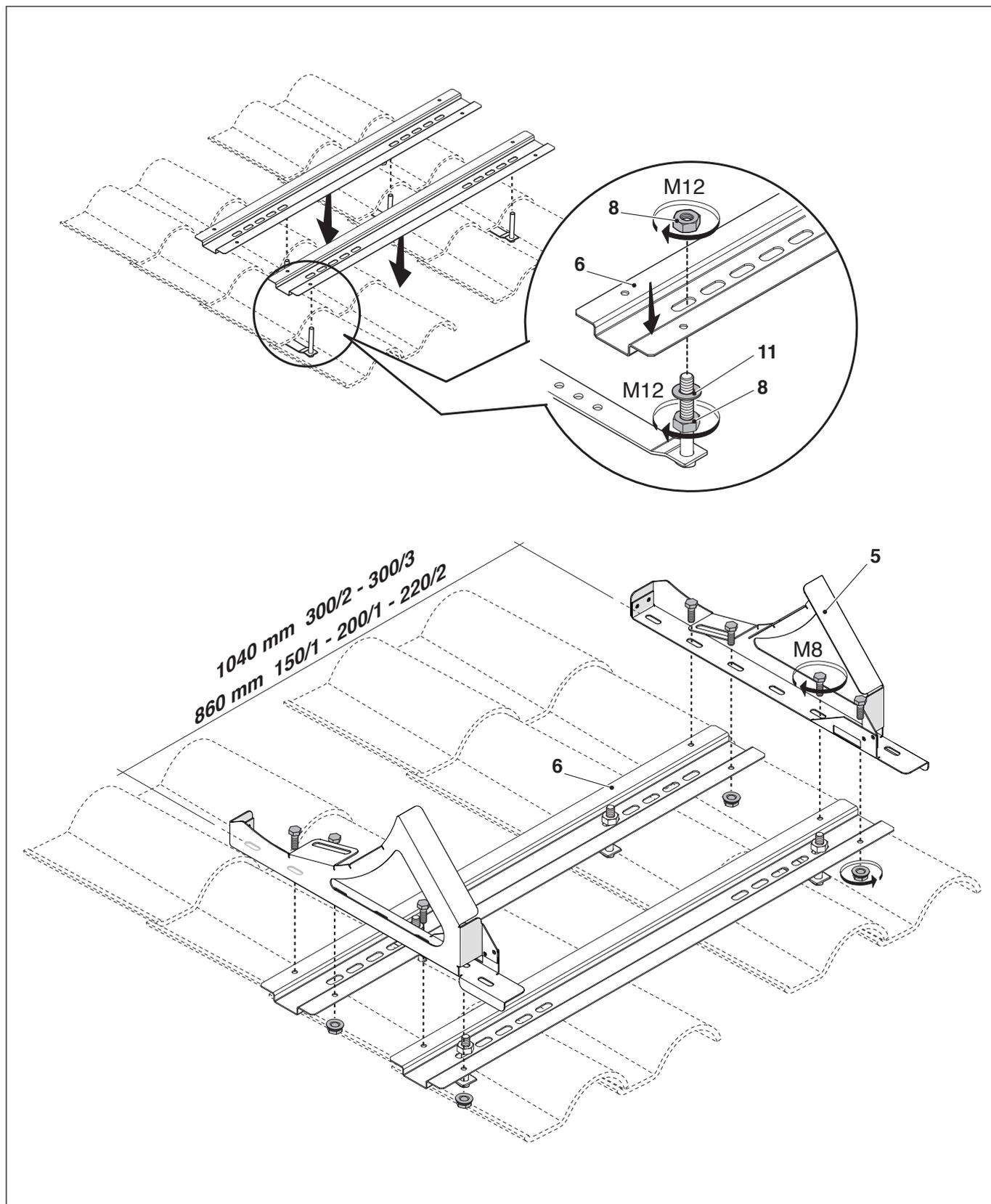
Posizionare il bollitore sui montanti (5) e fissarlo con le viti M8 (12).
