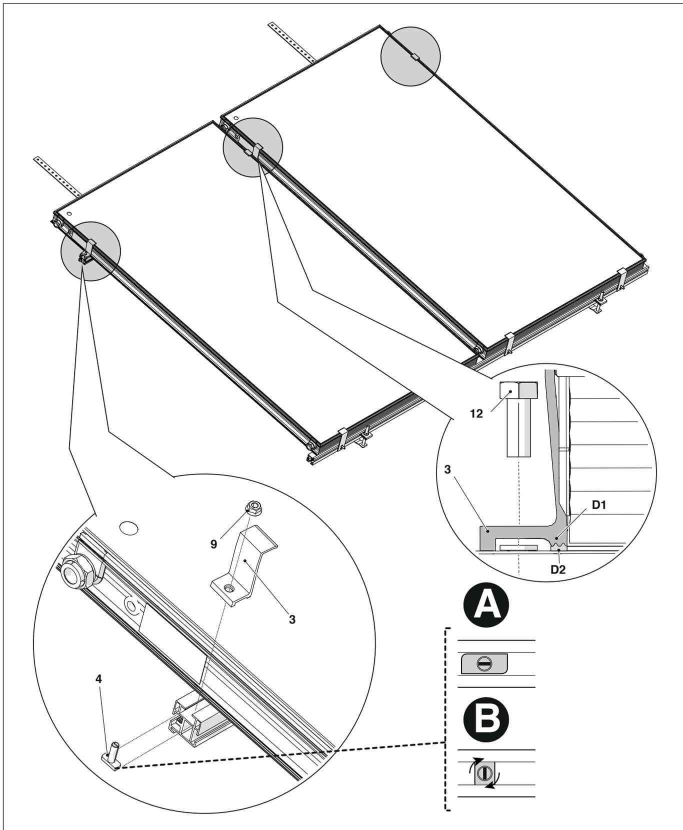
⚠ Posizione la vite a testa rettangolare (4) in posizione (A) nella barra di supporto superiore e approntare la staffa di bloccaggio (3) sulla vite. Inserire la staffa di bloccaggio sul profilo del collettore ruotandola leggermente. Ruotare la vite a testa rettangolare in posizione (B) e fissare il dado (9) alla vite. Dopo il serraggio verificare che l'intaglio della vite sia in POSIZIONE ORTOGONALE rispetto alla disposizione della barra.
