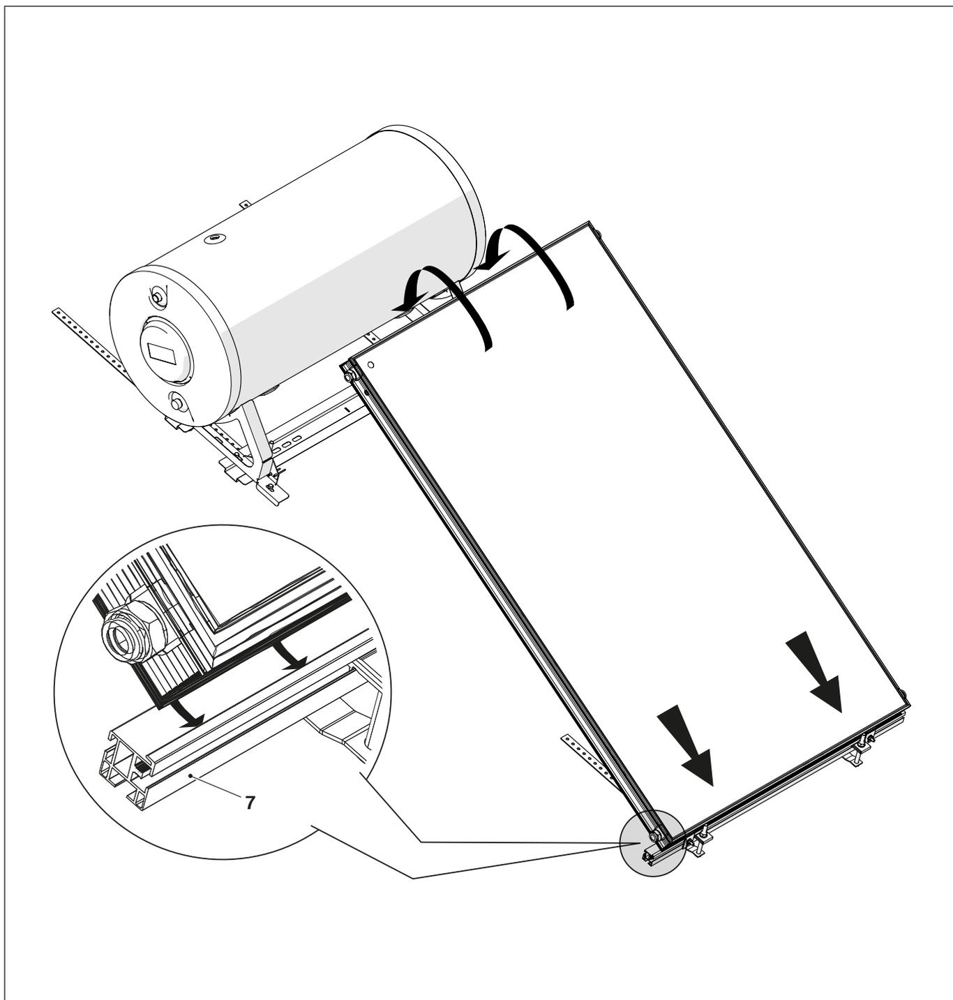
Fissare il collettore con le staffe di bloccaggio superiori (3).
