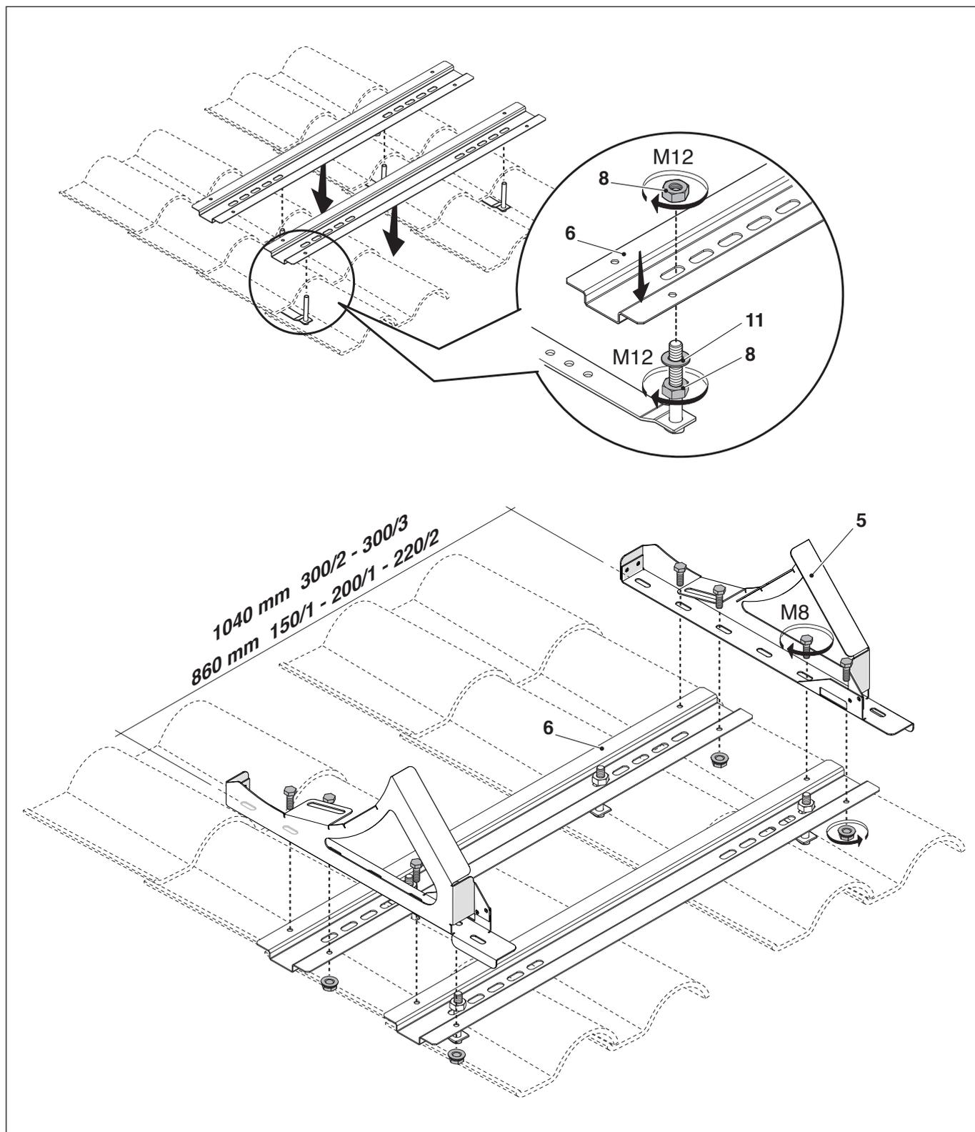
Posizionare il bollitore sui montanti (5) e fissarlo con le viti M8 (12).
