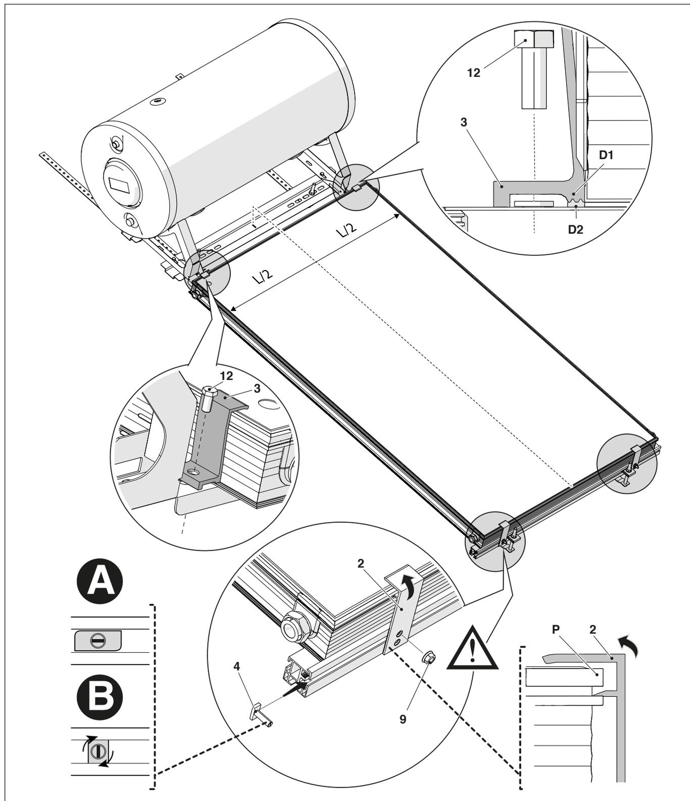
⚠ Posizionare la vite a testa rettangolare (4) in posizione (A) nella barra di supporto inferiore e approntare la staffa di bloccaggio (2) o (3) sulla vite. Inserire la staffa di bloccaggio (2) sul profilo (P) del collettore ruotandola leggermente. Ruotare la vite a testa rettangolare in posizione (B) e fissare il dado (9) alla vite. Dopo il serraggio verificare che l'intaglio della vite sia in POSIZIONE ORTOGONALE rispetto alla disposizione della barra.
