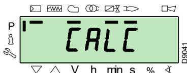
Il controllo fiamma calcolerà in automatico i punti da "P8" a "P2", distribuendoli in una retta. Essi sono teorici e devono essere verificati.
