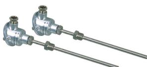
Il kit comprende due sensori di temperatura: uno per l'aria e uno per il rilevamento dei gas di scarico. Devono essere collegati all'interfaccia del kit di controllo dell'ossigeno per consentire il calcolo dell'efficienza dell'LMV 52. Il valore viene visualizzato sul display dell'AZL.
