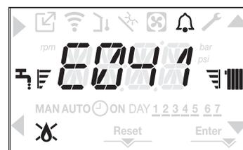
Trascorso il tempo transitorio, se l'anomalia persiste, viene visualizzato il codice di anomalia E040. Con caldaia in anomalia E040 è necessario procedere al caricamento manuale agendo sul rubinetto di riempimento (A) sino a che la pressione raggiunge un valore compreso tra 1 e 1,5 bar. Successivamente premere RESET.
