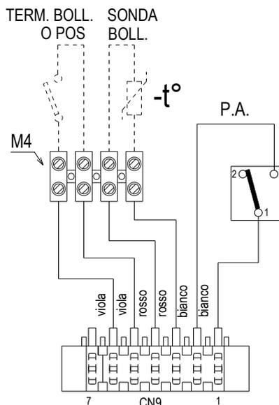
**⚠** Nella configurazione caldaia+bollitore esterno con sonda - CASO C - aggiungere un cavallotto sull'ingresso TERM. BOLL della morsetteria M4.
