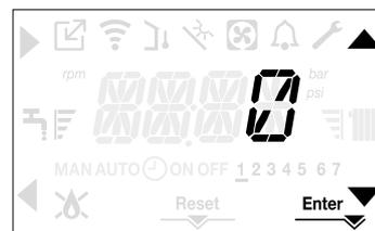
Tutte le volte che la caldaia è alimentata viene eseguito un ciclo di sfiato della durata di 6 min. Il display visualizza il messaggio -AIR e si accende l'icona RESET.
