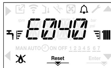
Chiudere successivamente il rubinetto di riempimento assicurandosi di sentire lo scatto meccanico. A termine del caricamento procedere con il ciclo di sfiato automatico come descritto nel paragrafo "2.14 Riempimento dell'impianto di riscaldamento ed eliminazione dell'aria".
