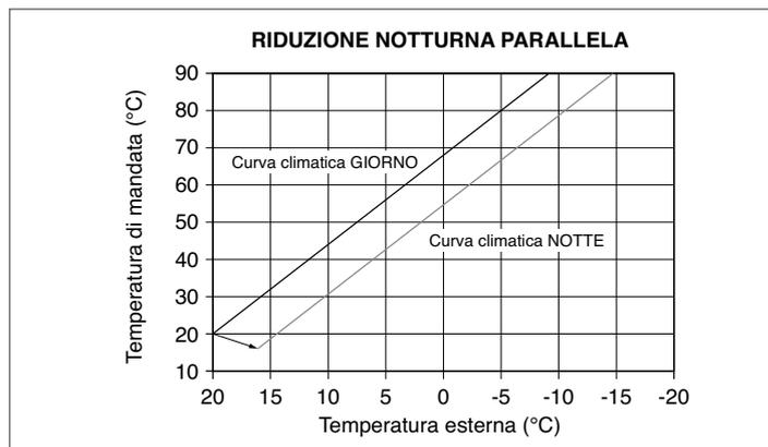
L'utente può indirettamente intervenire sul valore di setpoint RISCALDAMENTO andando ancora una volta ad introdurre, sul valore di temperatura di riferimento GIORNO (20°C) piuttosto che NOTTE (16°C), un offset che può variare all'interno del range [-5 ÷ +5]. Per la correzione dell'offset fare riferimento al paragrafo "3.8 Regolazione della temperatura acqua di riscaldamento con sonda esterna collegata".
