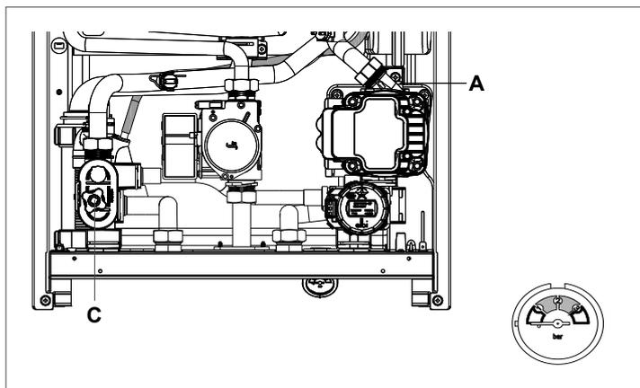
NOTA: le operazioni di riempimento dell'impianto devono essere fatte agendo sul rubinetto di riempimento (**esterno alla caldaia**) con caldaia in stato OFF.
