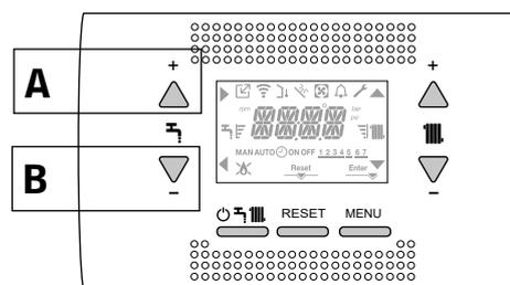
La successiva pressione dei tasti A o B consente di impostare il valore del setpoint sanitario incrementandolo o decrementandolo all'interno del range prestabilito, con step di 0.5°C. Le barre di livello a fianco dell'icona riscaldamento mostrano il valore di setpoint impostato rispetto al range di funzionamento:
