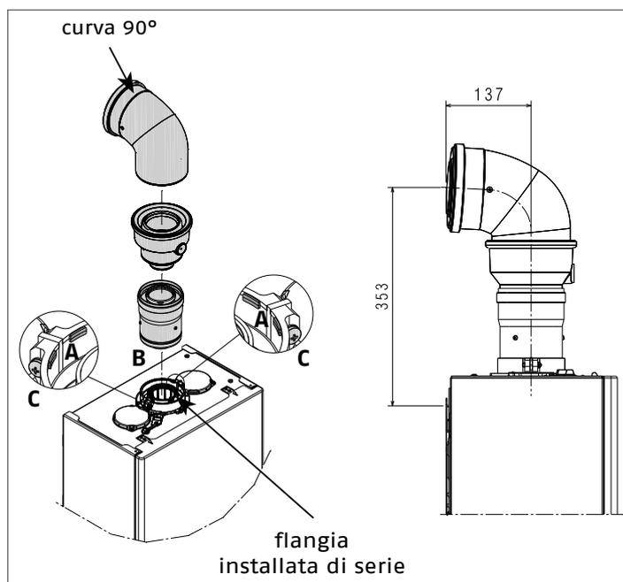
**Condotti sdoppiati  $\varnothing 80$  con intubamento  $\varnothing 50 - \varnothing 60 - \varnothing 80$**
