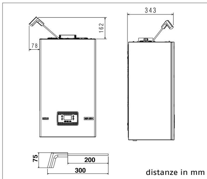
**⚠** In caso di installazione è **INDISPENSABILE** prevedere gli spazi necessari per l'introduzione dello strumento per l'analisi combustione. Riportiamo un disegno campione dove le distanze tra caldaia e pensile/nicchia sono state ottenute utilizzando uno strumento di lunghezza 300 mm. Strumenti di lunghezze superiori necessitano di spazi maggiori.
