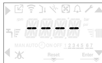
In questo caso i sistemi antigelo e antibloccaggio sono disattivati. Svotare l'impianto termico e sanitario se c'è pericolo di gelo.
