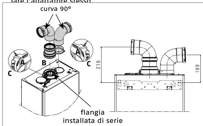
In caso si utilizzi il kit sdoppiatore da  $\varnothing 60-100$  a  $\varnothing 80-80$  al posto del sistema sdoppiato, si determina una perdita nelle lunghezze massime come indicato in tabella.
