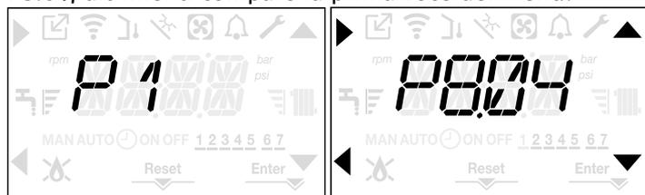
L'accesso alla programmazione parametri del menu **TECNICO** è protetta da password; premendo una seconda volta il tasto MENU per almeno 2sec, si visualizza la scritta **PWD** lampeggiante con frequenza 0,5sec ON e 0,5sec OFF per una durata di 2sec.
