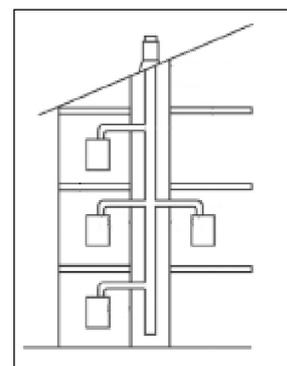
⚠ Il montaggio dei condotti deve essere operato in modo tale da evitare risacche di condensa che impedirebbero la corretta evacuazione dei prodotti della combustione.
