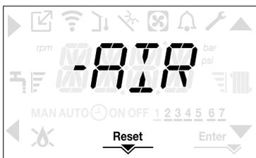
Il ciclo di sfiato può essere preventivamente interrotto premendo il tasto 2 (si accende l'icona RESET sul display). Il ciclo di sfiato può essere anche interrotto, se caldaia non in stato OFF, da una richiesta di calore sanitario.
