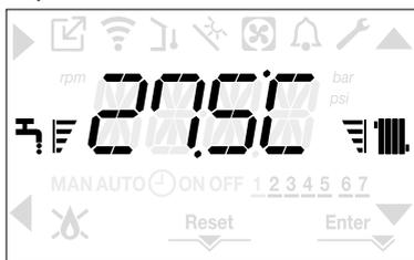
Sull'interfaccia viene normalmente visualizzata la temperatura di mandata a meno che non sia in corso una richiesta sanitaria, nel qual caso viene visualizzata la temperatura dell'acqua sanitaria.
