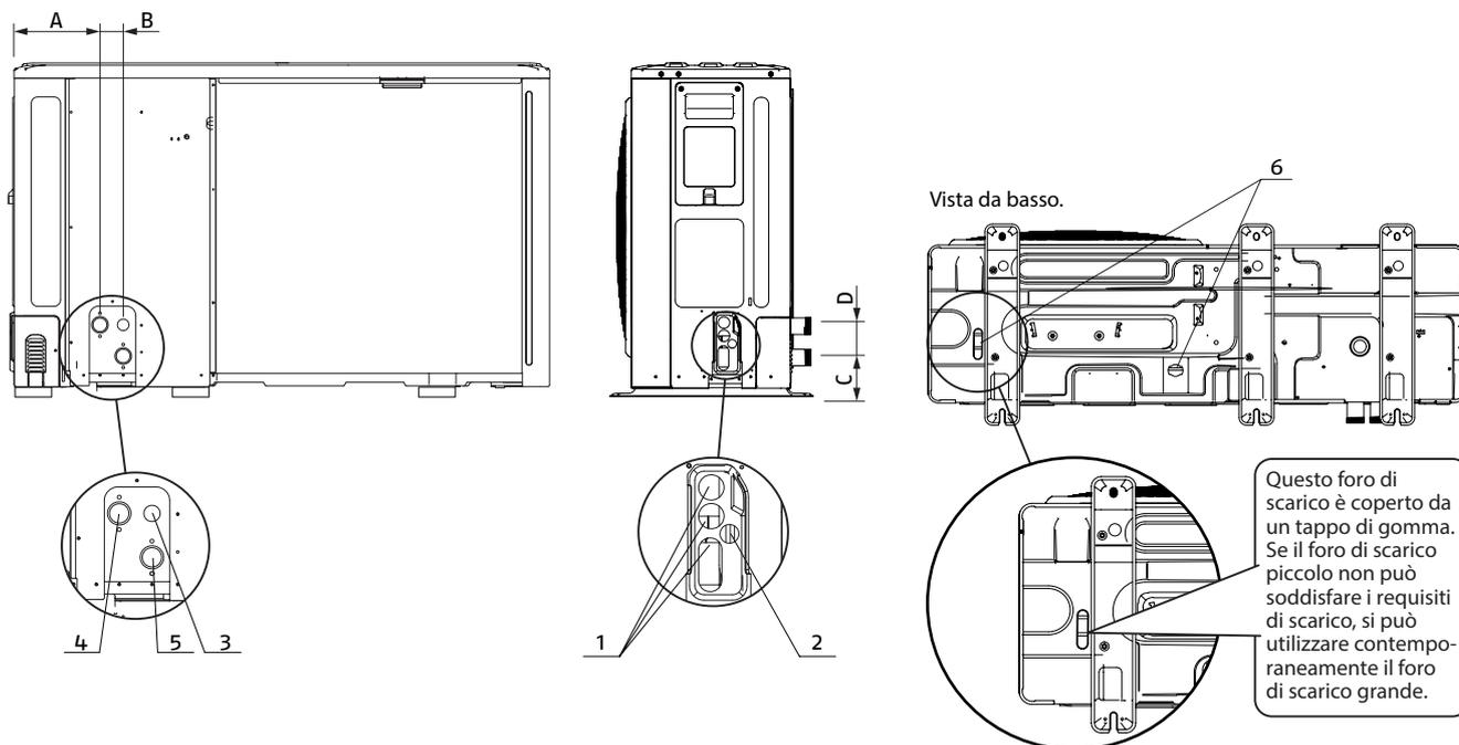
Questo foro di scarico è coperto da un tappo di gomma. Se il foro di scarico piccolo non può soddisfare i requisiti di scarico, si può utilizzare contemporaneamente il foro di scarico grande.
