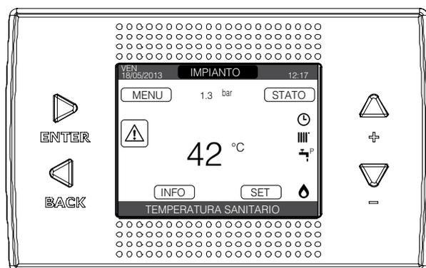
L'interfaccia utente dell'unità, anche denominata interfaccia REC10MH, è installata remotamente.
