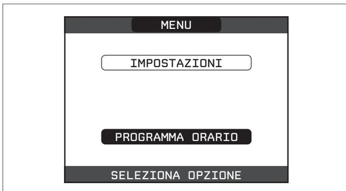
Da questo menù è possibile accedere alla visualizzazione e regolazione della programmazione oraria per le funzioni riscaldamento della zona. Per ciascun giorno della settimana è possibile impostare fino a 4 fasce, caratterizzate da un orario di inizio e un orario di fine.
