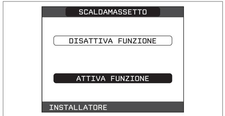
La funzione scaldamassetto, quando attiva, viene segnalata nella schermata principale dal messaggio scorrevole a piè di pagina FUNZIONE SCALDAMASSETTO IN CORSO – TEMPERATURA DI MANDATA, mentre sulla scheda elettronica lampeggiano in modo alternato i led rosso e verde con frequenza 1sec ON – 1sec OFF.
