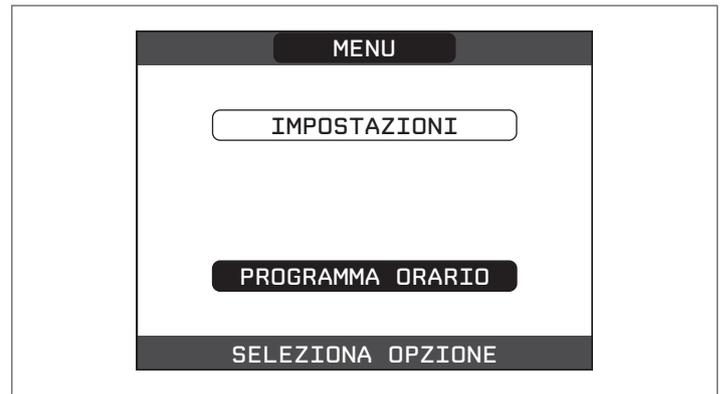
Da questo menù è possibile accedere alla visualizzazione e regolazione della programmazione oraria per le funzioni riscaldamento della zona piuttosto che per il bollitore sanitario. Per ciascun giorno della settimana è possibile impostare fino a 4 fasce, caratterizzate da un orario di inizio e un orario di fine.
