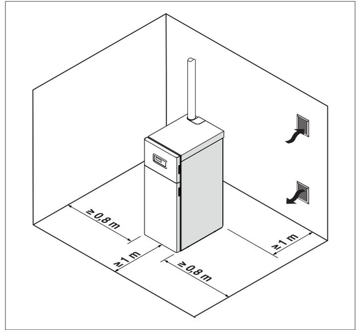
Il modulo termico **TAU Unit** può essere installato in locali permanentemente ventilati dotati di aperture di aerazione adeguatamente dimensionate e conformi alle Norme Tecniche e Regolamenti vigenti nel sito di installazione.
