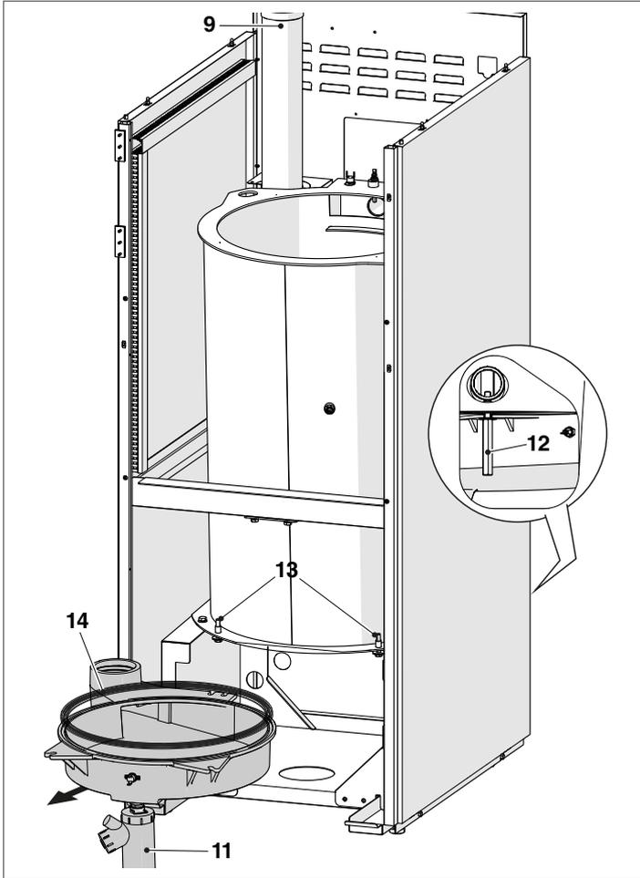
Completate le operazioni di manutenzione, rimontare i componenti operando in senso contrario a quanto descritto.
