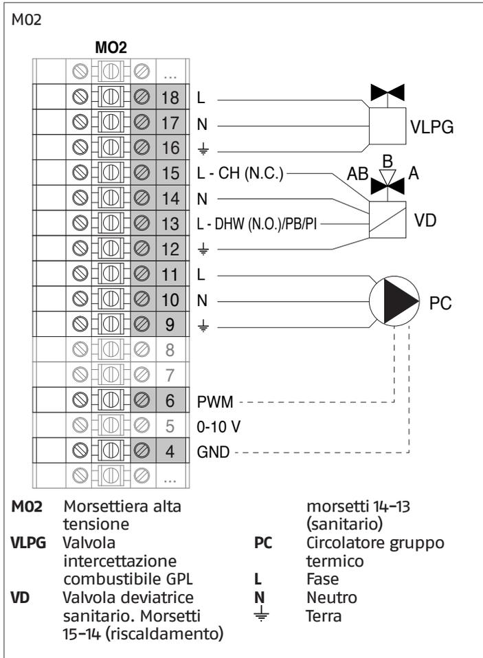
Configurazione parametri di base Schema 4
