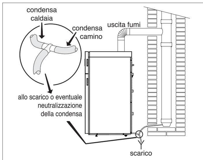
⚠ Eventuali dispositivi di neutralizzazione della condensa potranno essere collegati dopo il sifone. Per il calcolo della durata della carica di neutralizzazione deve essere valutato lo stato di consumo del neutralizzatore dopo un anno di funzionamento. Sulla base di tale informazione si potrà estrapolare la durata totale della carica.
