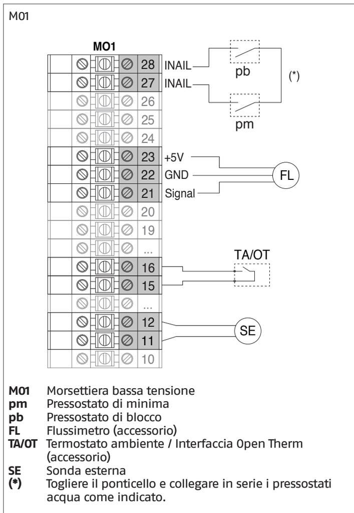
Schema 1.1: circuito con modulo termico collegato direttamente all'impianto con due zone di riscaldamento dirette
