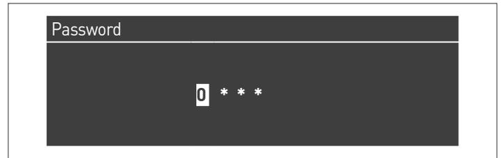
Inserire una cifra alla volta utilizzando i tasti ▲ / ▼ per incrementare/diminuire il valore numerico. Una volta impostato il valore corretto confermare premendo il tasto ●.
