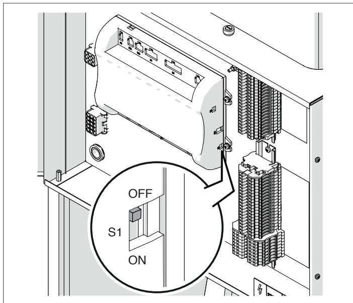
Posizionare l'interruttore generale dell'impianto su acceso (ON) e SOLO l'interruttore principale del modulo termico da configurare su (I).
