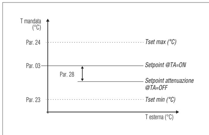
**!** La sonda esterna (accessorio) non è richesta e se è collegata il valore di temperatura esterna rilevato non influenza il setpoint impostato.
