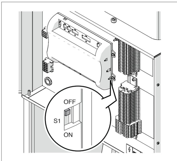
Posizionare l'interruttore generale dell'impianto su acceso (ON) e SOLO l'interruttore principale del modulo termico da configurare su (I).
