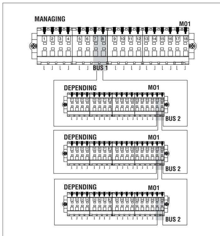
**⚠** Il collegamento bus ai moduli termici depending deve essere effettuato in parallelo senza terminale di chiusura che causerebbe un corto circuito.
