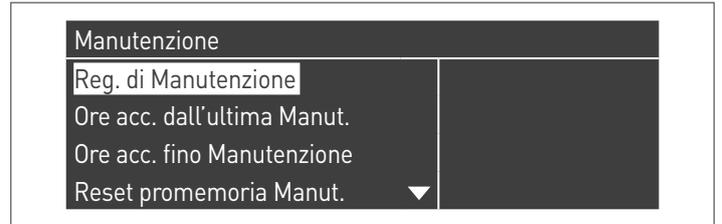
Nel menu "Impostazioni" → "Imp. caldaia" → "Manutenzione" sono riportati i comandi avanzati di questa funzione che però sono disponibili solo se si accede con la password costruttore. Se necessario agire a questo livello di accesso, contattare il Servizio Tecnico di Assistenza.
