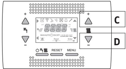
La successiva pressione del tasto **C** oppure **D** consente di impostare il valore del setpoint riscaldamento all'interno del range prestabilito: [40°C ÷ 80,5°C] per impianti alta temperatura [20°C ÷ 45 °C] per impianti bassa temperatura. con step di 0,5°C.
