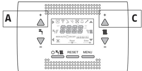
Tutte le volte che la caldaia è alimentata viene eseguito un ciclo di sfiato della durata di 4 min (modello KIS) - 6 min (modello IS). Il display visualizza **-AIR** e si accende l'icona **RESET**.
