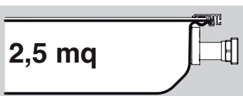
Capteur 2,5 m 2 VERTICAL avec COFFRE à 2 raccords G 1" SENKRECHTER 2,5 qm Kollektor mit WANNE und 2 ANSCHLÜSSEN G 1"
