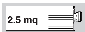
Capteur 2.5 m 2 VERTICAL avec CHÂSSIS (2 raccords G 1") SENKRECHTER 2.5 qm Kollektor mit RAHMEN (2 Anschlüsse G 1")
